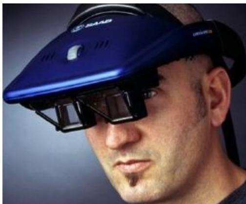
Bild 13. Addvisor 150 har en upplösning på imponerande 1280 x 1024 pixlar, men begränsas av synfältet på 60 grader. [20]
