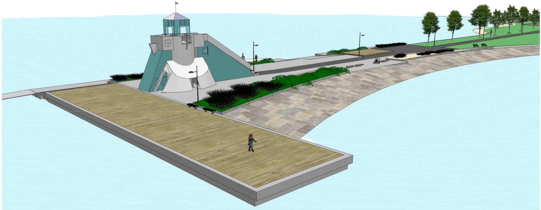
Kuva 60. Lankkupintainen laituri sekä rantaa suojaava kaarevalinjainen luonnonkivilados.
