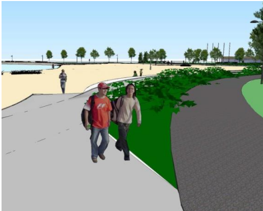
Kuva 68. Istutuskaistat rajaavat olevan asfalttivyylän ja uuden betonikivipintaisen väylän toisistaan.
