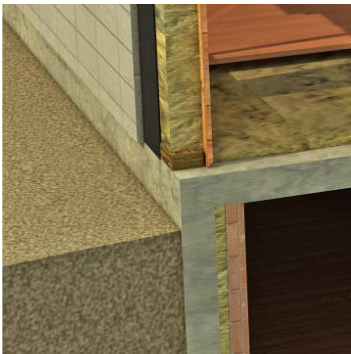
Kuva 2. Tuulettumaton ulkoseinärakenne (Hometalkoot.fi)
