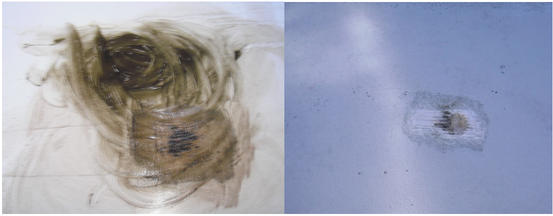
Kuva 27. Liattu ja osaksi hiottu lasikuitupala ja sama pala puhdistettuna Sponge-Jet-puhallusmenetelmällä
