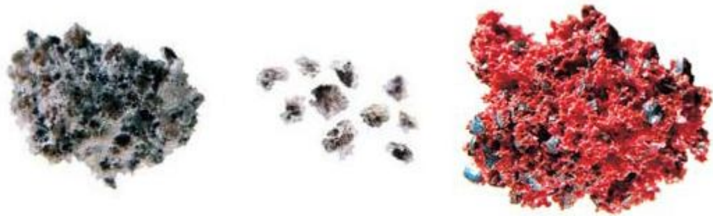
Kuva 7. Polyuretaanisienet Silver 30 Sponge Media, Silver 320DG Sponge Media ja Red G-40 Sponge Media. Mittasuhte 10:1. (21.)
