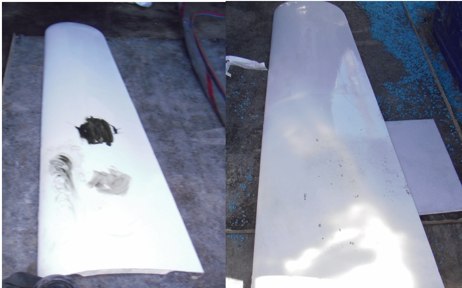
Kuva 25. Liattu pinnoitettu lasikuidun pala ja Sponge-Jet-puhallusmenetelmällä puhdistettu sama pala
