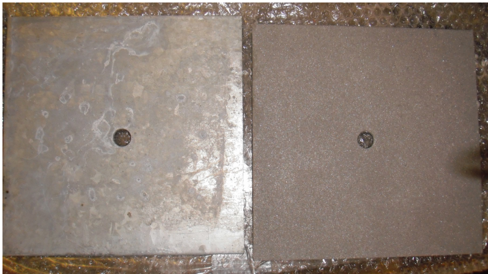
Kuva 22. Sinkitty teräslevy ja Sponge-Jet-puhallusmenetelmällä puhdistettu sinkitty teräslevy
