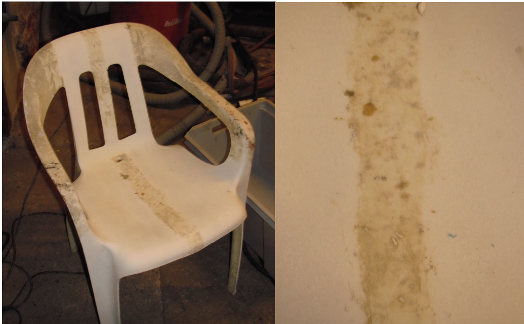
Kuva 11. Osaksi Sponge-Jet-puhallusmenetelmällä puhallettu puutarhatuoli ja lähikuva sen pinnasta
