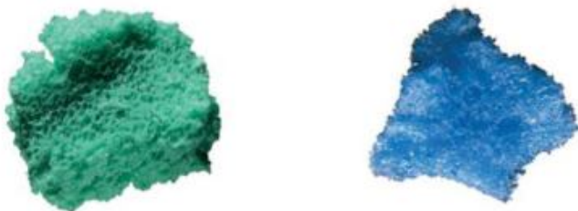
Kuva 9. Polyuretaanisienet Green Sponge Media ja Blue Sponge Media. Kuvan mittasuhte 10:1. (23.)
