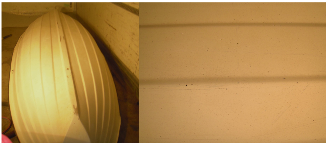
Kuva 24. Sponge-Jet-puhallusmenetelmällä puhdistettu pinnoitettu lasikuituvene
