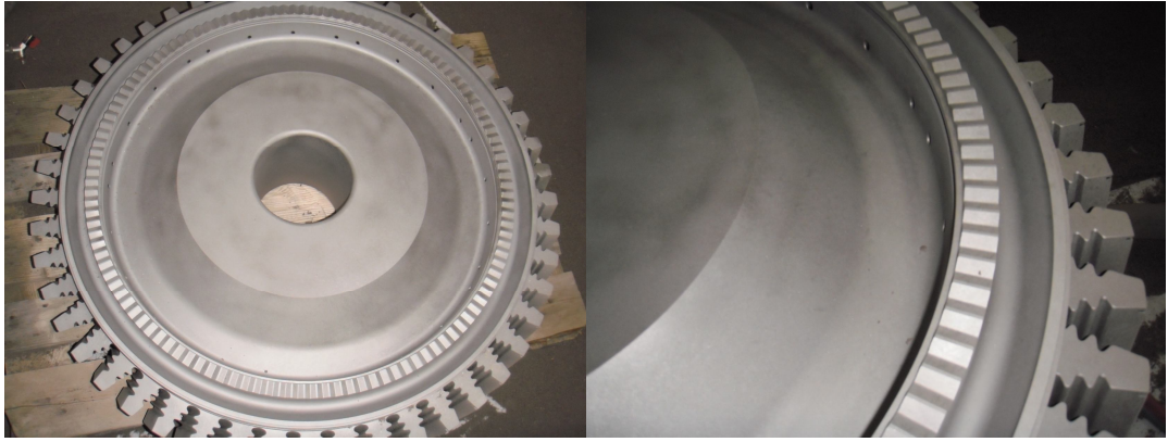
Kuva 19. Sponge-Jet-puhallusmenetelmällä puhdistettu kaasuturbiinin osa
