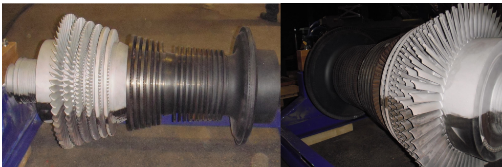
Kuva 20. Osaksi Sponge-Jet-puhallusmenetelmällä puhdistettu kaasuturbiini
