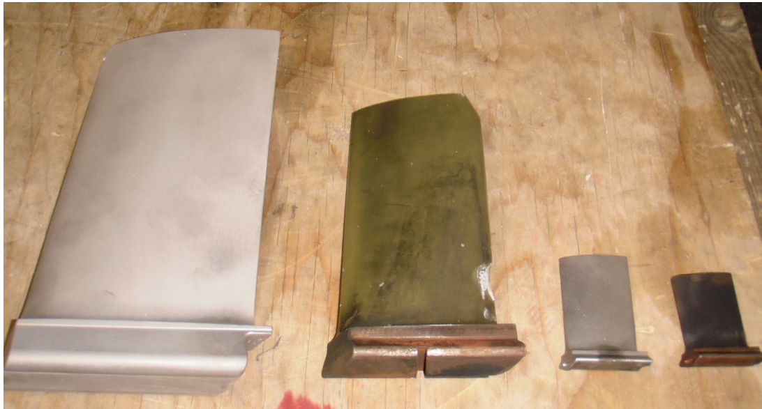
Kuva 18. Likaisia ja Sponge-Jet-puhallusmenetelmällä puhallettuja erikokoisia kaasuturbiinin siipiä
