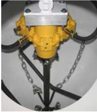
Kuva 3. Sponge-Jet-puhalluslaitteen sekoittaja ja syöttöruuvi (4; 12.)
