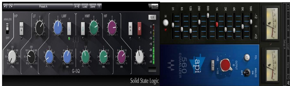
KUVA 2. Parametrinen Taajuuskorjain SSL ja graafinen taajuuskorjain API 560.
