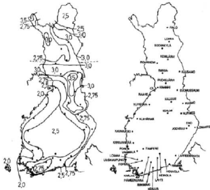
Bild 14 s_k -värden för snölast på mark (RIL 205-1-2009:33).
