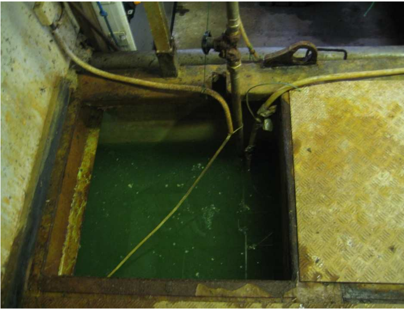
Kuva 10. Ferrosulfaatin valmistussäiliö. Valokuva Suvi Niemi 2011
