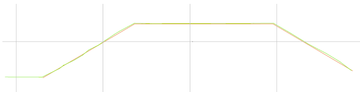
Figur 5. Tvärsnitt av teoretisk modell (röd) och verklig byggd struktur (grön) - (se Backända 2020 - Tallqvist Ab)
