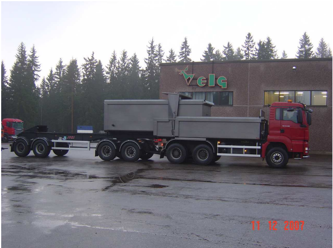
Kuva 5. Kasetoinnissa kasettilava siirtyy perävaunusta kuorma-auton lavalle.
