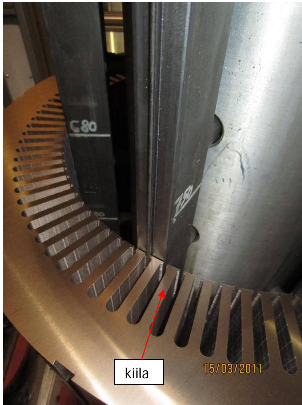
Kuva 6 Kiiloja on kolme tuurnalla, ja ne vaihdetaan levyssä olevien urien mukaan. Kiilat paisutetaan nippujen ladonnan aikana ulos päin, jolla varmistetaan pinon suora kasaantuminen.
