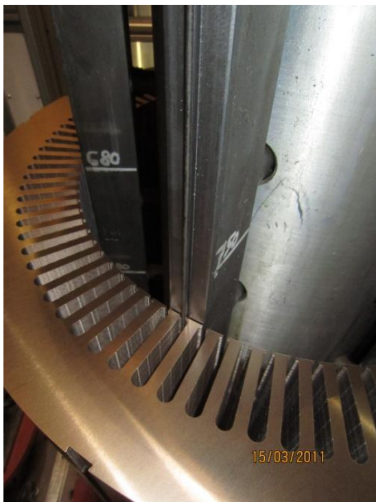
Kuva 4. Lähikuva tuurnassa olevasta kiilasta, joka ohjaa levyjä.
