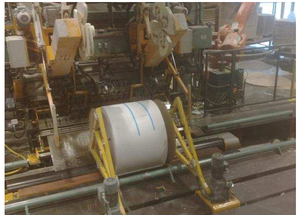
Kuva 2.4 Päätylaput asetetaan paikalleen
