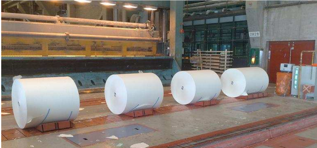
Kuva 5.13 Pysäytinläpillä vuoroaan odottavia rullia
