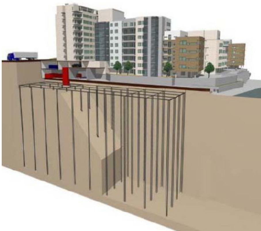
Kuva 4. Porakaivokentän poikkileikkaus suurkohteessa.
