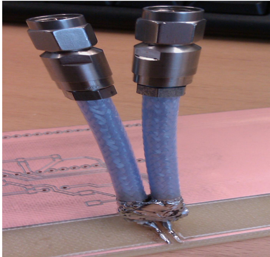
Kuva 10. Mittapää juotettuna dipoliantenniin
