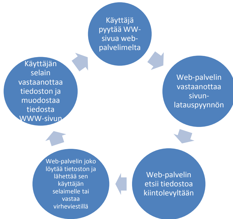
KUVIO 3. Web-palvelimen toimintaperiaate
