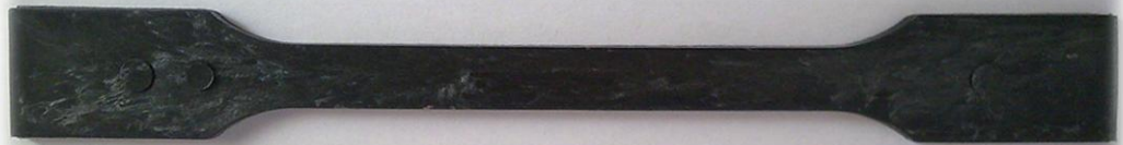
KUVIO 19. Ruiskuvalettu koesauva (PP+40 p% puuvillaa)
