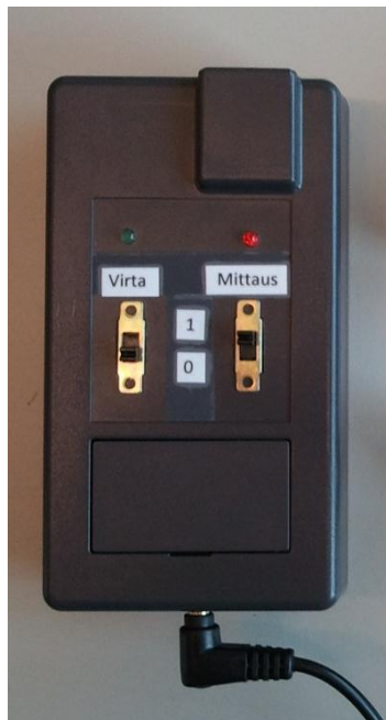
KUVA 4. Laitteen kannessa sijaitsevat kytkimet ja ledit
