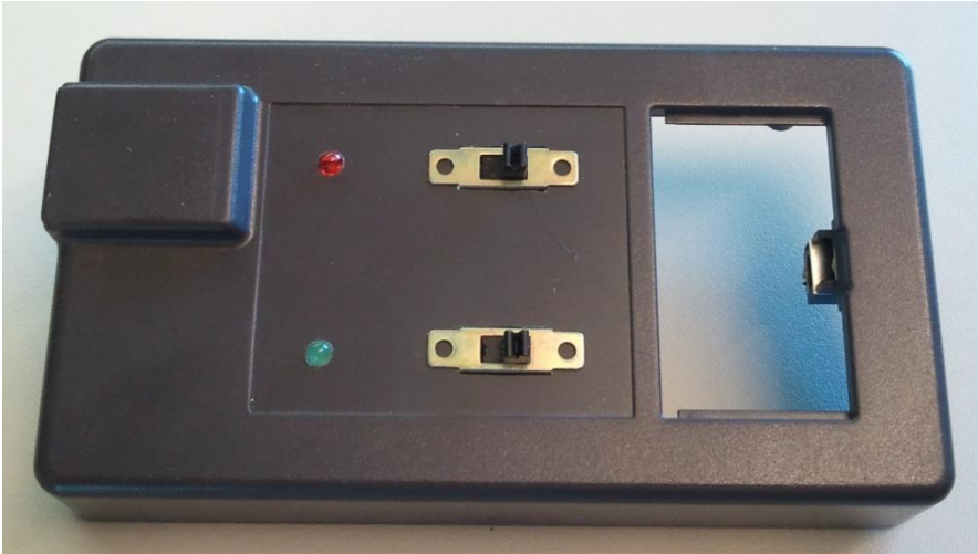
KUVA 13. Kotelon kansi, jossa kiinni ledit ja kytkimet
