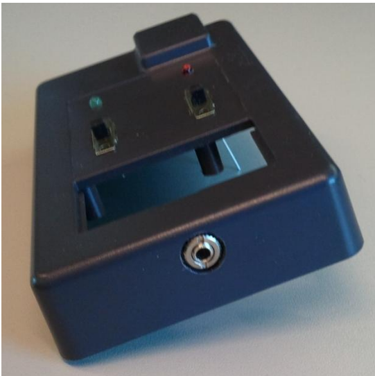
KUVA 14. Kotelon kansi takaapäin, jolloin näkyy myös mikrofonin 2,5 mm naarasliitin
