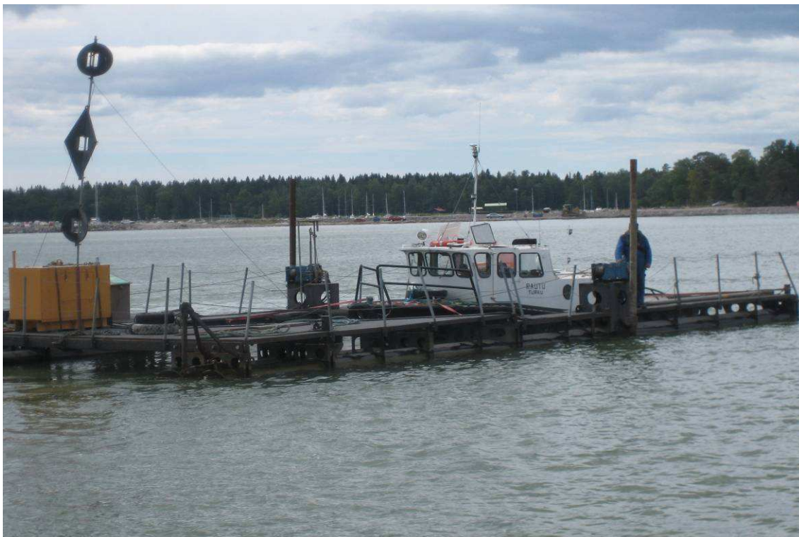
Kuva 7. Tankohara, jossa on GPS-paikannus.
