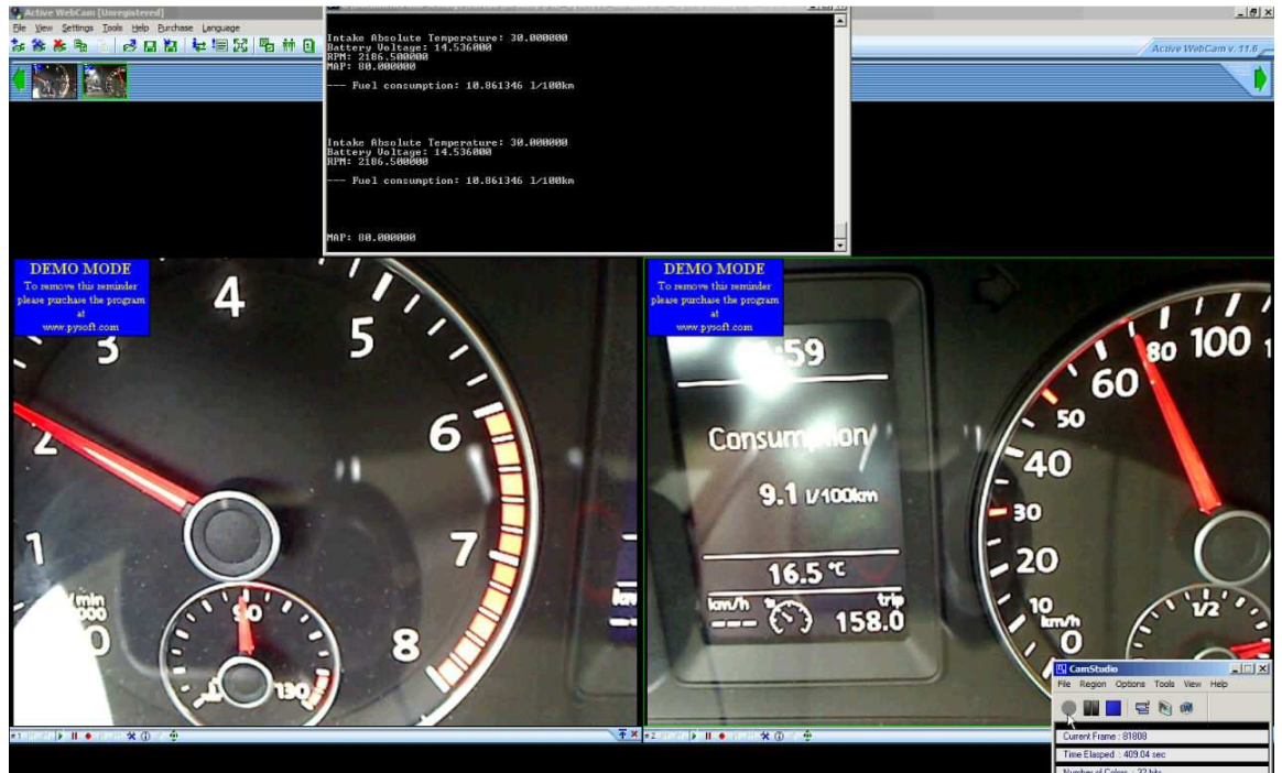
Kuva 19. Mittauksesta otettu kuva. Laskettu polttoainenkulutus näyttää noin 10 l/100 km.
