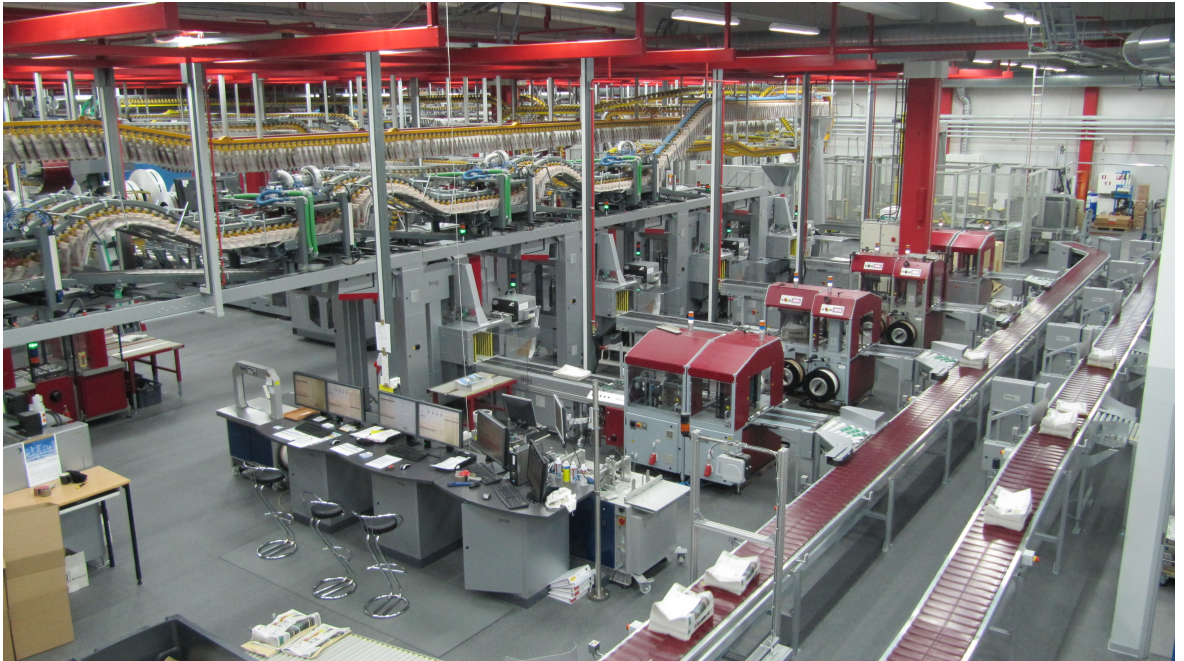
KUVIO 7. Line Master, stakkerit, sitomakoneet ja nippulinja tositoimissa
