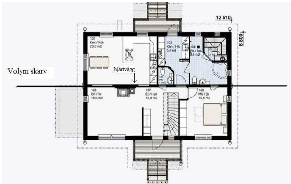
Bild 1. Exempel på placering av volymskarv (www.simonselement.fi)
