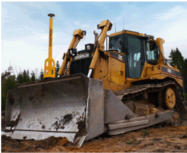
Kuva2. Puskukone varustettuna GPS-automaatiolla.(Novatron Oy verkkosivut[viitattu 28.2.2009])
