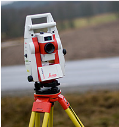
Kuva5. Takymetri pystytettynä.(Scanlaser oy verkkosivut[viitattu 19.3.2009])
