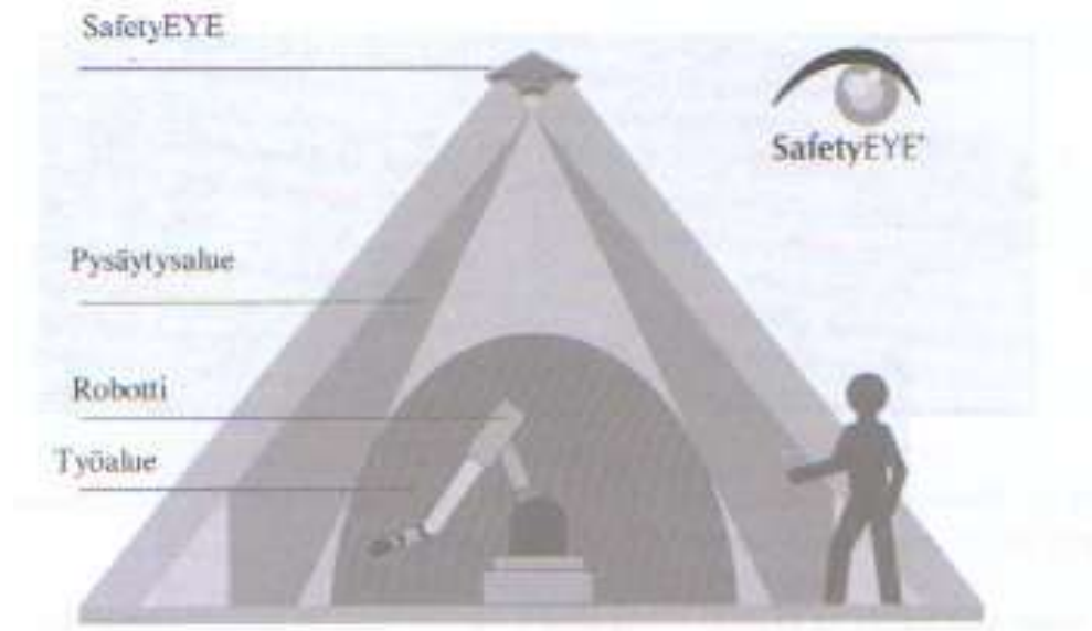
Kuvio 12. Poikkileikkaus SafetyEYEn muodostamasta valvontakartiosta. (Malm ym. 2008, 33.)
