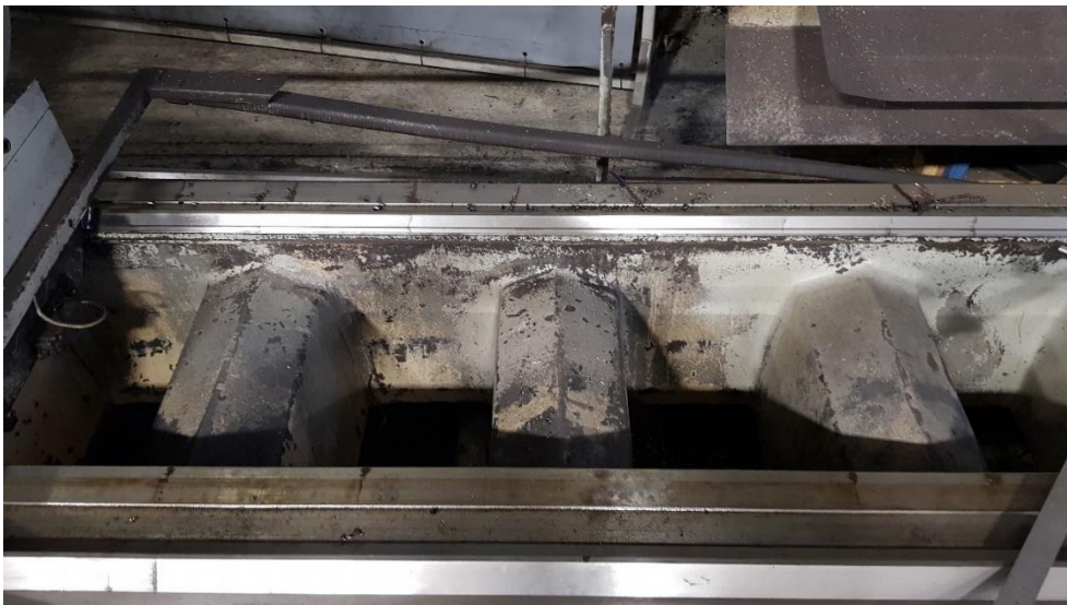
KUVA 14. ZMM CU1000 -sorvin rungon väli jäykisteet
