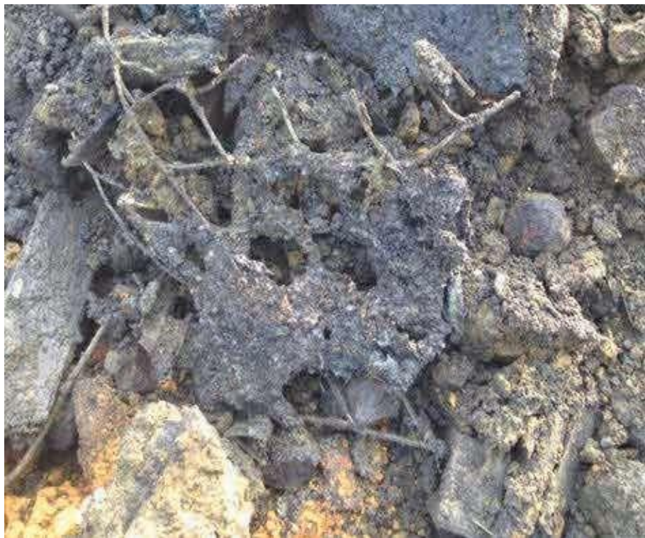
Kuva 33. Erittäin vahingoittunutta/hajonnutta asbestieristettä/kuitujätettä ylöskaive- tussa täyttömaassa. (Hydrock).
