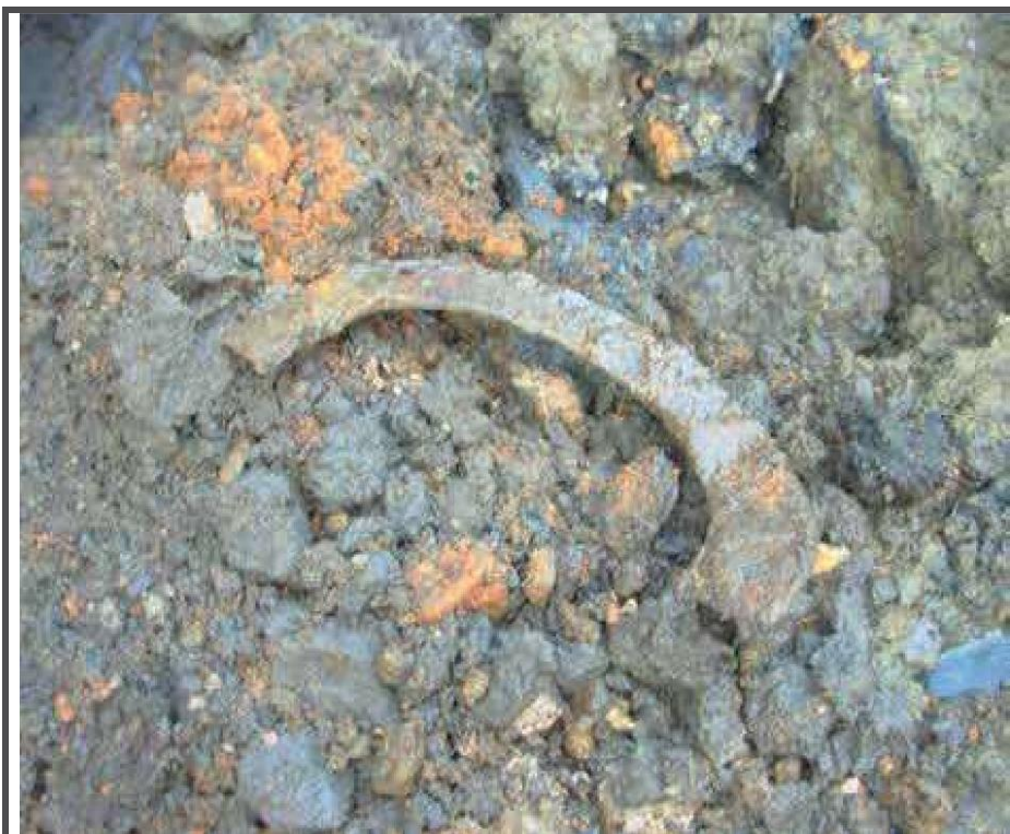
Kuva 13. Lähikuva kokoonpuristuneesta asbestikuidusta tehdystä tiivisteestä täyttömaassa. (Soilfix Limited).
