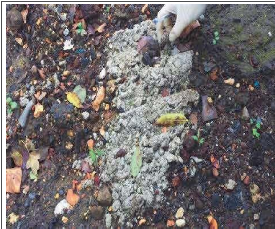
Kuva 31. Erittäin vahingoittunutta/hajonnutta asbestieristettä/kuitujätettä täyttömaan pinnalla. (Hydrock).
