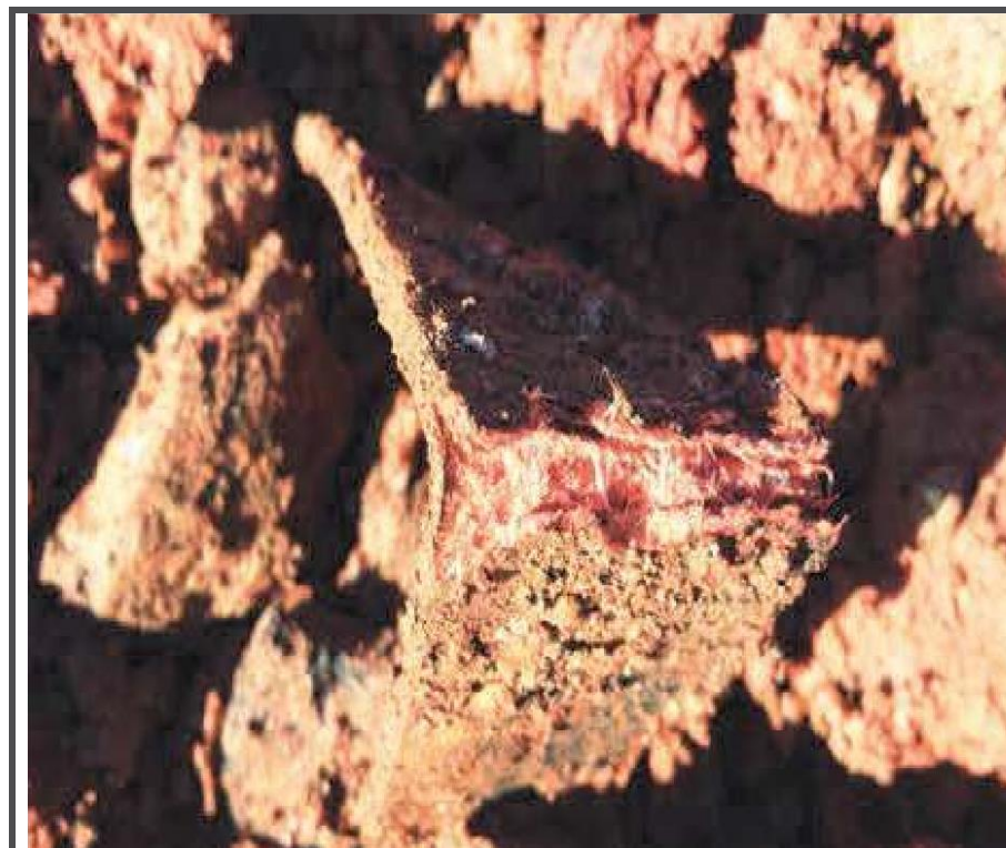
Kuva 14. Lähikuva rapautuneesta asbestikuidusta tehdystä tiivisteestä ylöskaivetussa täyttömaassa. (Hydrock.)
