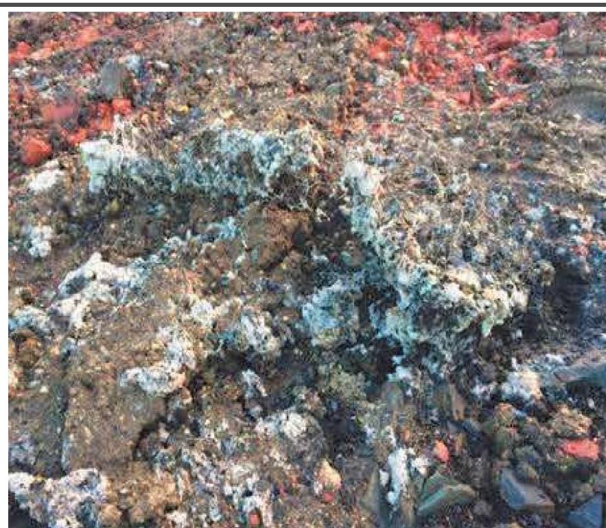
Kuva 28. Kammottava täyttömaan kontaminaatio, jossa asbestieristejä- tettä kanaverkossa. (Soilfix Limited).
