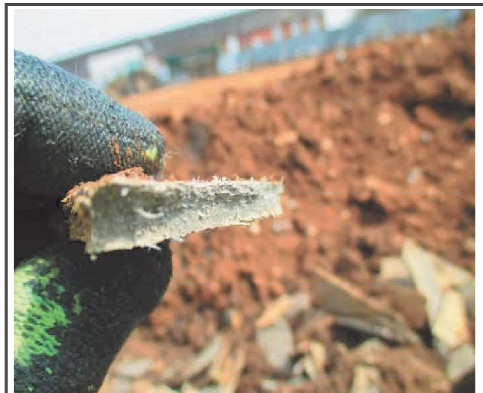
Kuva 6. Lähikuva vahingoittuneesta asbestieristyslevyn palasesta, joka kerättiin pois kaivannosta. (VertaseFLI).
