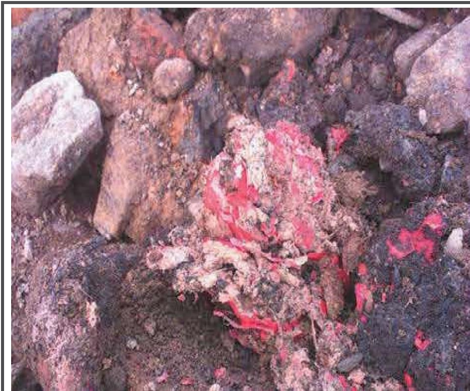
Kuva 25. Lähikuva punapäällysteisestä kuituisesta asbestieristejätteestä. (Soilfix Limited).
