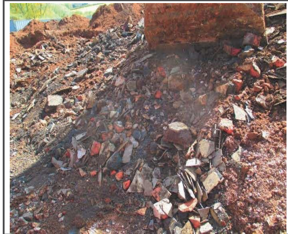
Kuva 4. Täyttömaata, jossa vahingoittunutta asbestipitoista materiaali-jätettä ja vapaita krysotiili-, amosiitti- ja krokidoliittikuituja. (VertaseFLI).
