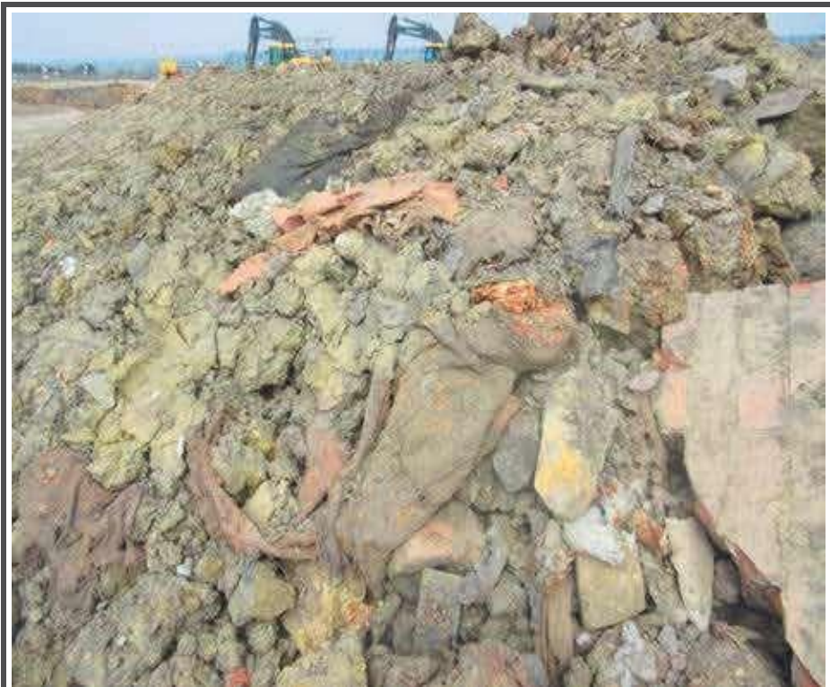
Kuva 15. Rapautunutta asbestitekstiilihuopaa ylöskaivetussa täyttömaassa. (Hydrock).
