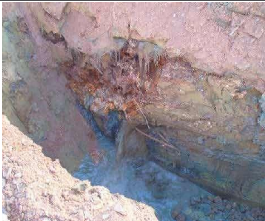
Kuva 35. Erittäin vahingoittunutta/hajonnutta asbestieristettä/kuitujätettä koe-kuopassa. (Hydrock).
