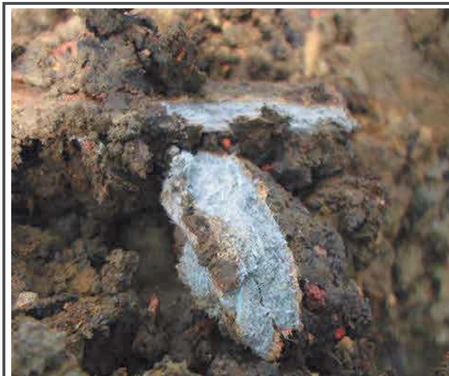
Kuva 11. Lähikuva vahingoittuneista asbestisementtipalasista täyttömaassa. (Hydrock).
