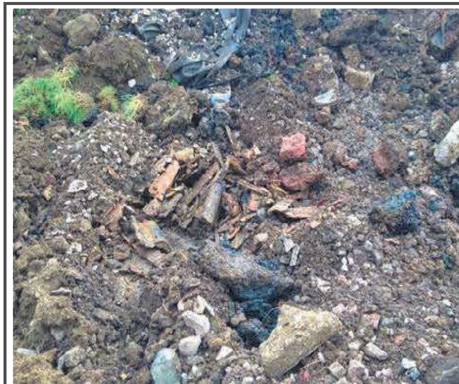
Kuva 10. Esimerkki rapautuneesta asbestisementtijätteestä ylöskaivetussa täyttömaassa. (Soilfix Limited).
