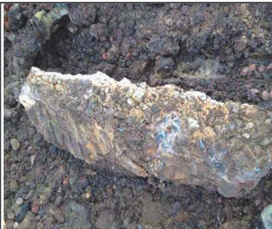
Kuva 7. Esimerkki asbestisementistä, joka löytyi betonilaatan alapuolelta. (Soilfix Limited).
