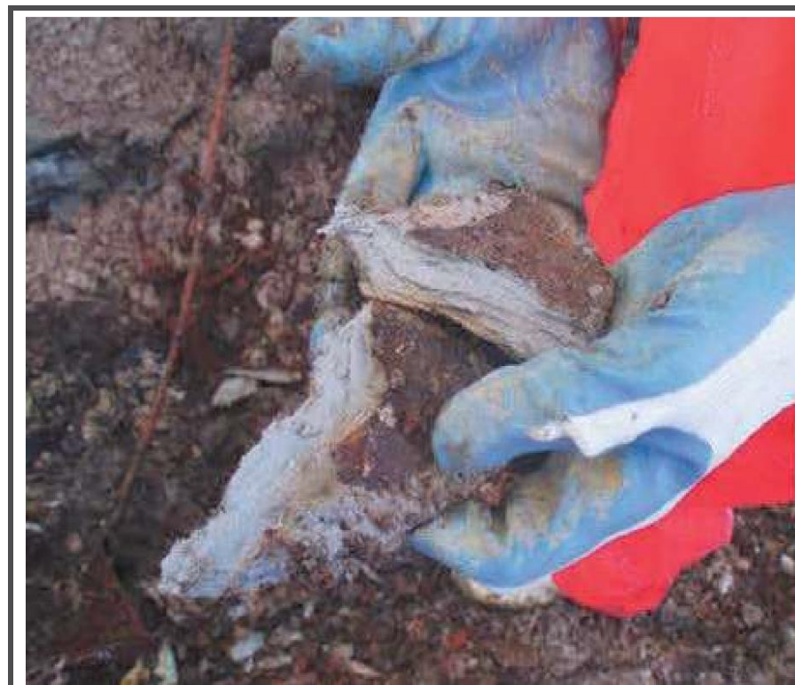
Kuva 24. Lähikuva vahingoittuneesta asbestieristyslaatasta ylöskaivetussa täyttömaassa. (Hydrock).
