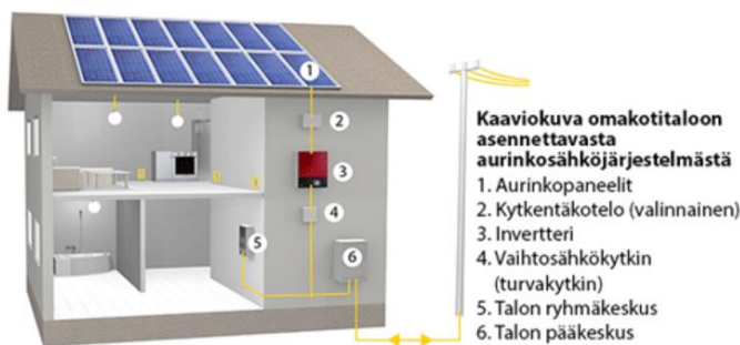
KUVA 8. Aurinkosähköjärjestelmän asentaminen. (Areva Solar, 2019)
