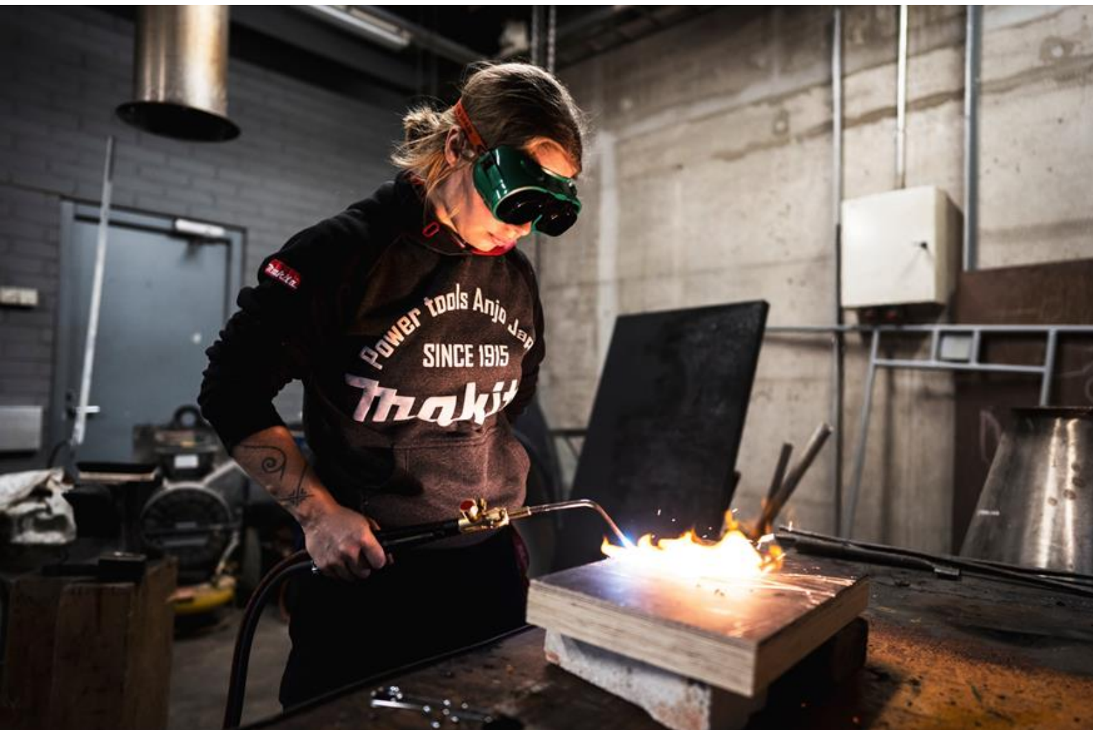
Kuva 15. Vanerin polttamista asetyleeni – happi -kaasuseoksella. Kuva: Ville Kaakinen
