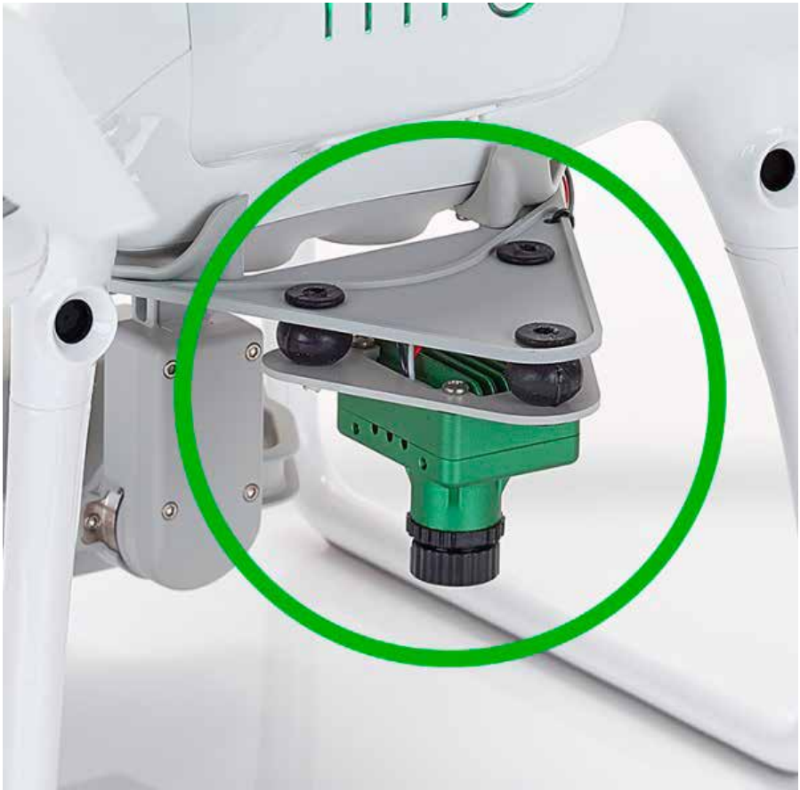
Kuva 10. Senteran lähi-infrapunakameramodifikaatio. Huomaa värinänvaimentimet kameratelineessä. Lisäksi kamerassa on oma Micro-Sd-muistikorttipaikka datan tallennusta varten (Kuva: Sentera 2018).
