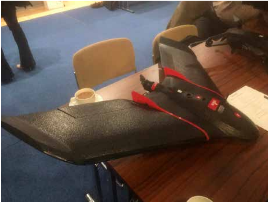
Kuva 4. Kiinteä-deltasiipinen yksimoottorinen työntöpotkurilla varustettu kartoitusdrooni. Rakenne on yksinkertainen ja kolhuja kestävä. Mallin lento-önlähtö tehdään kädestä tai tarkoitusta varten tehdyllä telineellä ja lasku maastoon (Kuva: Juha Tiainen 2018).
