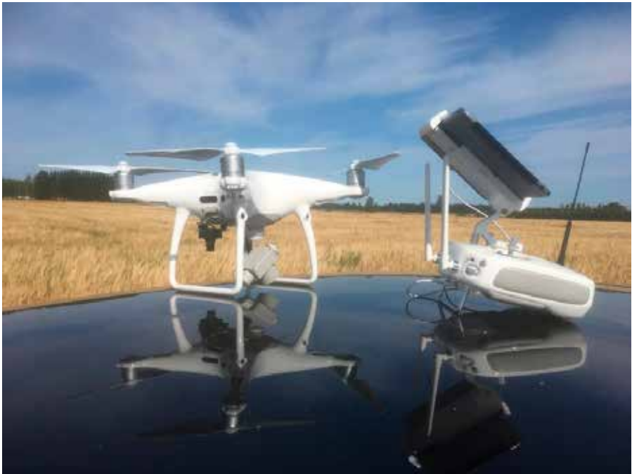
Kuva 5. Tyypillinen kartoituslentoihin pystyvä nelikopteri varusteineen (Kuva: Juha Tiainen 2018).
