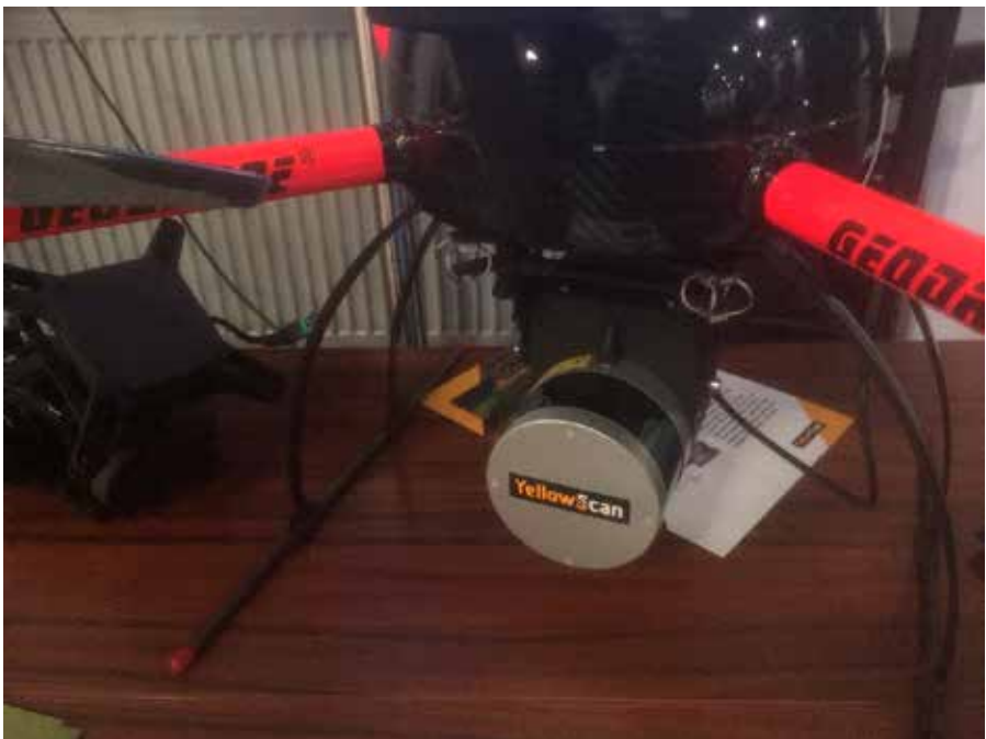
Kuva 8. Geodronen multikopterissa on mukana suorituskykyinen laserkeilain (Kuva: Juha Tiainen 2018).
