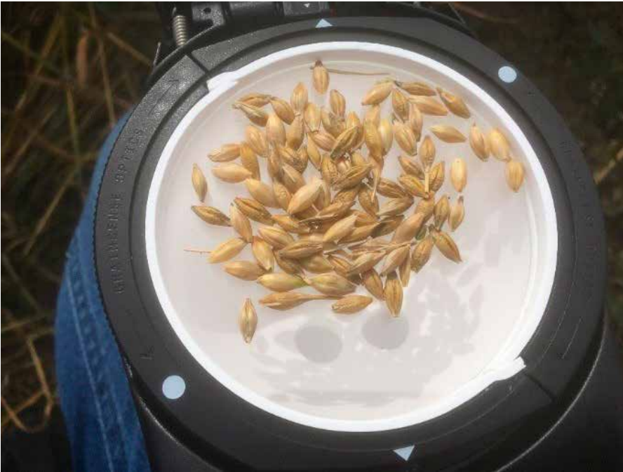
Kuva 21. Näytejyvät valmiina analysoitavaksi mittalasin päällä. Itse analyysi on kannen sulkemisen jälkeen noin muutaman sekunnin toimenpide (Kuva: Juha Tiainen 2018).
