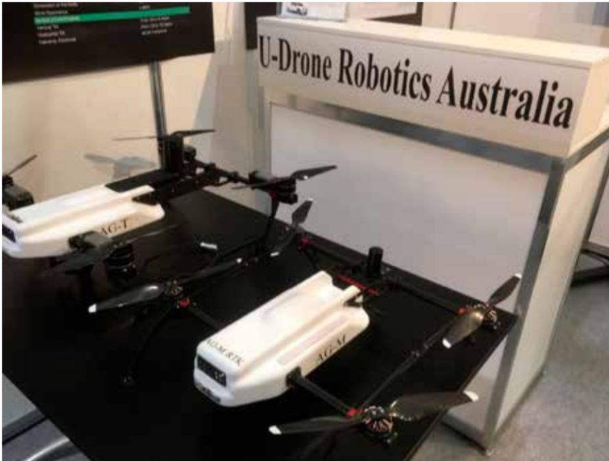
Kuva 6. Kasvinviljelyruiskutuksiinkin pystyvä RTK-drooni (Kuva: Juha Tiainen 2018).
