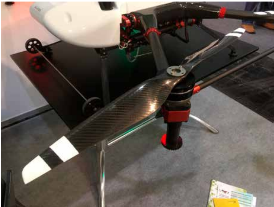
Kuva 7. Ruisku-RTK- droonin puomiston pää, jossa harjaton moottori, jonka alla on ruiskun säädettävä suutin (Kuva: Juha Tiainen 2018).
