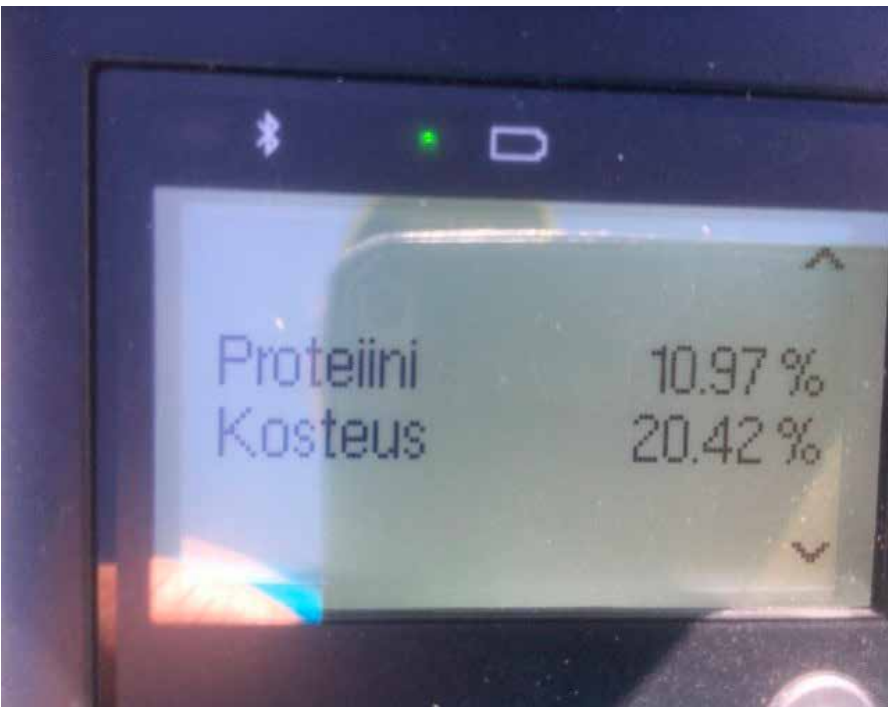
Kuva 22. Valokuvatallenne yhden koepisteen proteiini- ja kosteusprosentista. Näyttöä selaten saadaan myös hiilihydraatti- ja öljyprosentit selville näytteestä (Kuva: Juha Tiainen).
