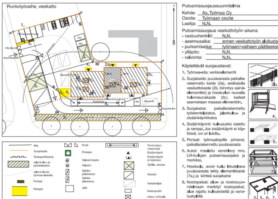
KUVA 7. Runko- ja vesikattotyövaiheen putoamissuojaussuunnitelma (8, s. 15)
