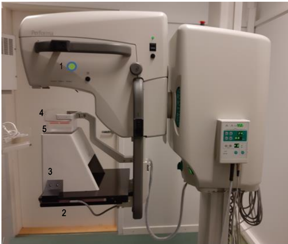
KUVIO 1. Demonstraatio mammografian suurennuskuvauksesta. 1.fokuspiste, 2. suoradigitalisoitu detektori, 3. suurennustorni, 4.puristuskaukalo, 5. rintaa simuloiva fantomi. (Kuva: Jenni Korhonen)
