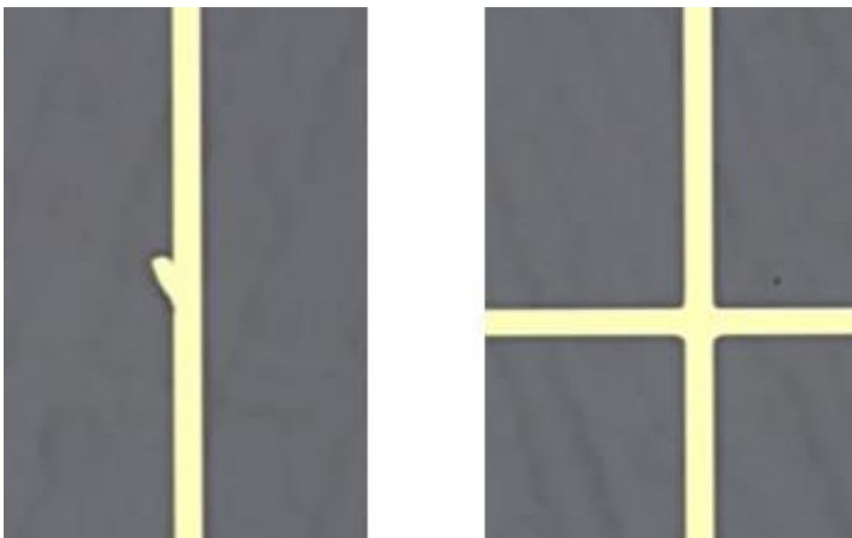
Kuva 7 Vasemmalla metallijäämä. Oikealla prosessin tuottama kohinavika näkyy pienenä mustana pisteenä. Jälkimmäinen vika ei ole metallirakenteiden tarkastuksessa oleellinen.
