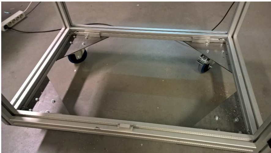
Kuva 27. Pyörät ja pyöräpidikkeet asennettuna testipenkkiin.
