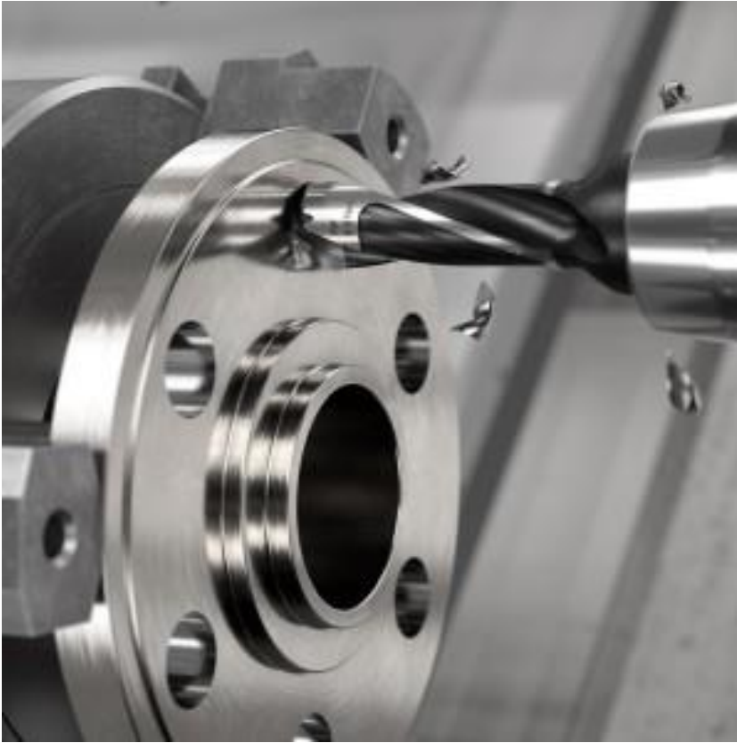
Figur 6. Borrning av svarvad detalj (Sandvik Coromant)
