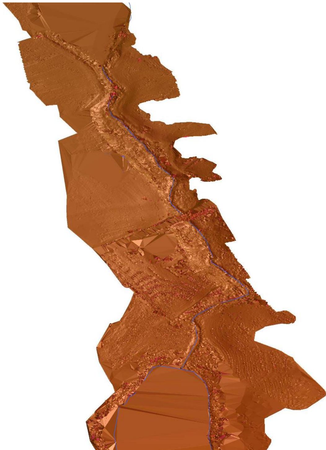
Kuva 14. Keilausaineistosta tuotettu maanpintamalli (Lappalainen 2020)
