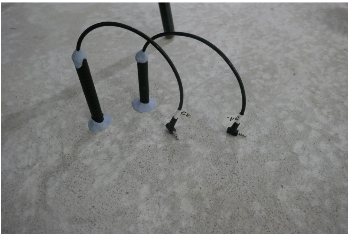
Kuva 1. Porareikämittauksessa käytettävät mittapää.
