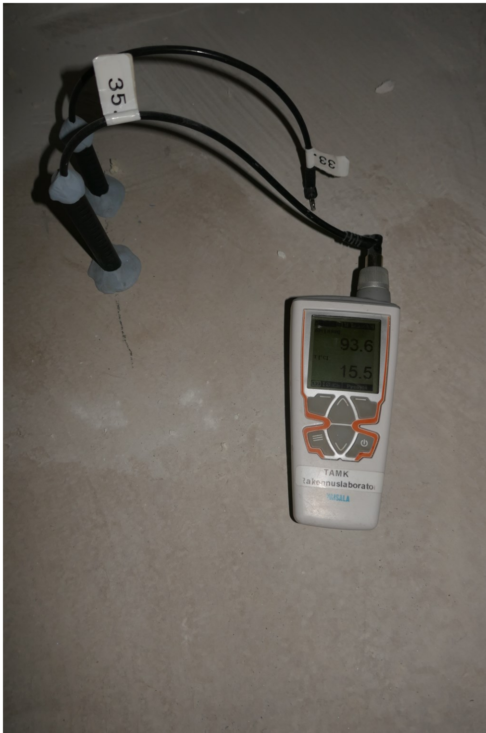
Kuva 2. Lattian kosteuden mittauslaite.
