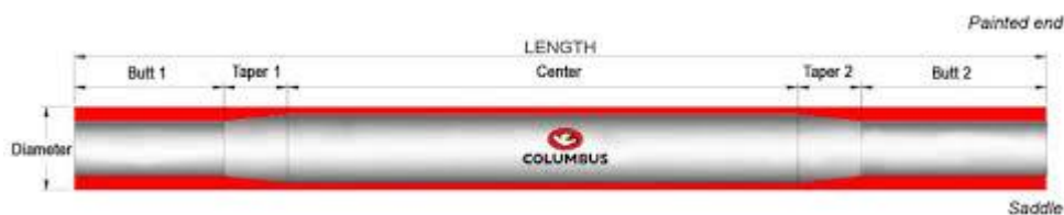
Kuva 19. Kaksoisohennetun putken läpileikkaus (10).
