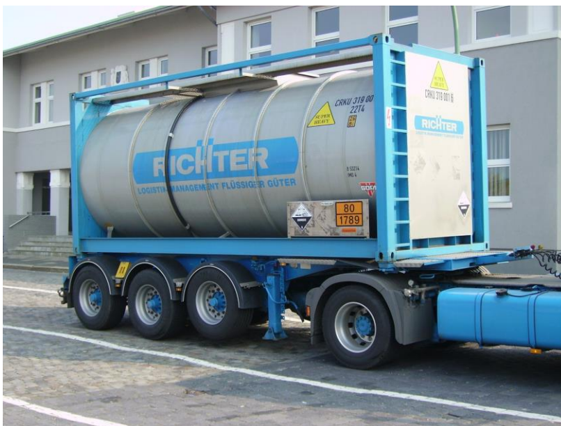
Kuva 7. Tankkikontti, merkittynä UN-numerolla ja vaarallisen aineen luokkamerkinnällä (Wikipedia www-sivut 2020).
