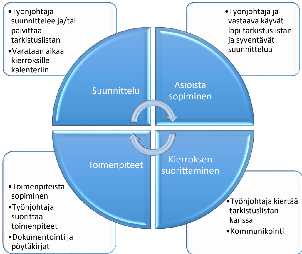
Kuva 6. Työmaan valvontakierroksen kiertokulku (Skanska s.a.)
