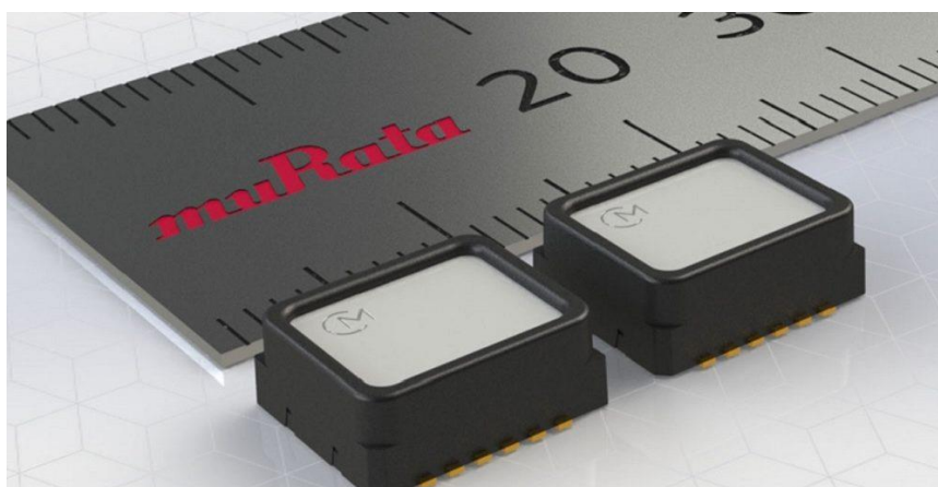
Kuva 13. Murata SCL3300-D01 -kaltevuusanturi (18).
