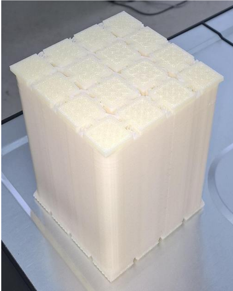
Kuva 22. uPrint -tulostimella tulostetut testikappaleet muodossa 4x4. Kuvan pylväiden mitat ovat 15x15x90 mm ja tulostuskerroksia on noin 360 (kerroksen paksuus 0,254 mm).
