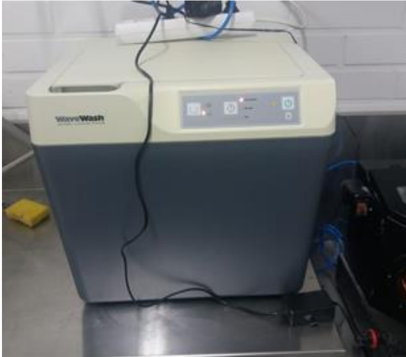
Kuva 23. Liuospesukone WaveWash Aalto-yliopiston ADDLab-laboratoriossa. WaveWash -pesukone käyttää tehokkaita liuotusaineita tukimateriaalien poistamiseen [38].
