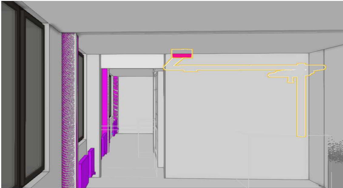
Kuva 6. IV-pääte on osittain alakaton sisässä ja törmää kattokiinnitteisen liukuoven kanssa.
