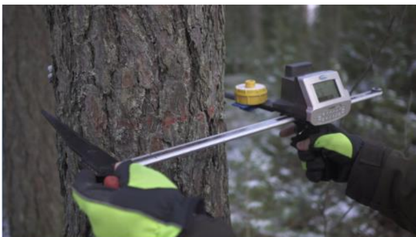
Kuva 3. Masser Excaliper ii mittasakset paikannuselektronikalla ja Haglöf Vertexin vastaanottimella varustettuna. (Savolainen, 2019)
