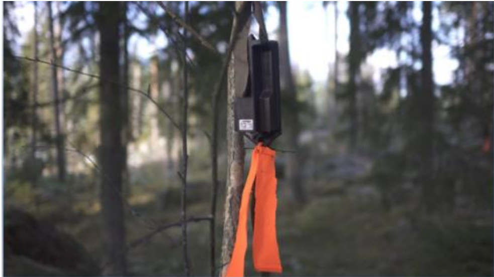
Kuva 2. Paikannuksessa käytettävät pseudoliitit levitetään koealalle ta-saisin välein. (Savolainen, 2019)
