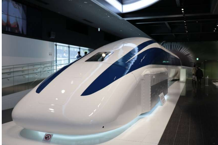
Kuva 15. Magneettisen levitaation testijuna Yamanashi MLX01 (Kimura Eiichi, 2014)
