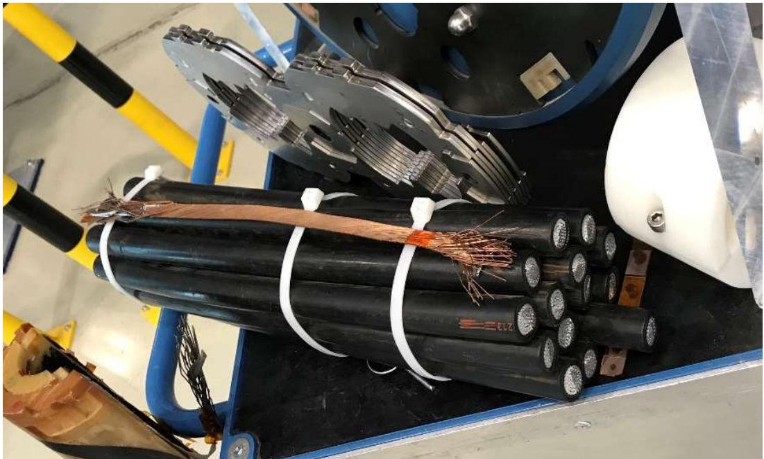
Kuva 17. Suprajohtava johdin kaapelinipun päällä
