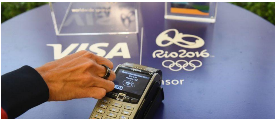
Kuva 8. Maksutapahtuman hoitaminen NFC-sirun sisältämällä sormuksella
