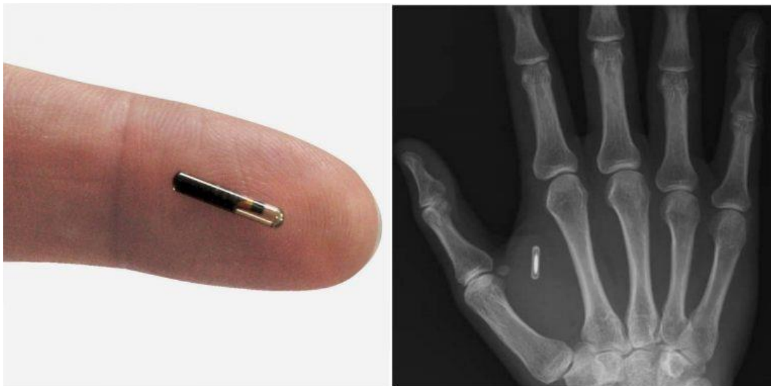
Kuva 9. Ihon alle asennettavan mikrosirun koko ja yleisin paikka implantille havainnollistettuna.
