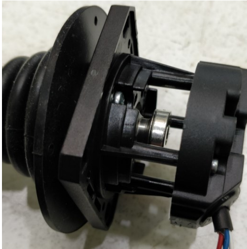
KUVA 18. Hall-tekniikkaan perustuvan ohjaussauvan avattu runko
