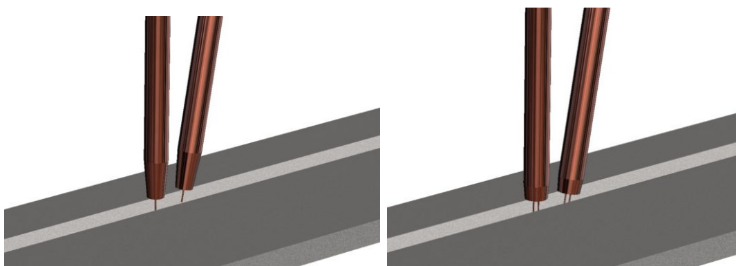
KUVA 13. Vasemmalla Tandem SAW ja oikealla Tandem Twin SAW (Pemamek Oy n.d.e)
