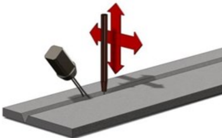
KUVA 14. Elektromekaanisen railon seurannan toimintaperiaate (Pemamek 2020)
