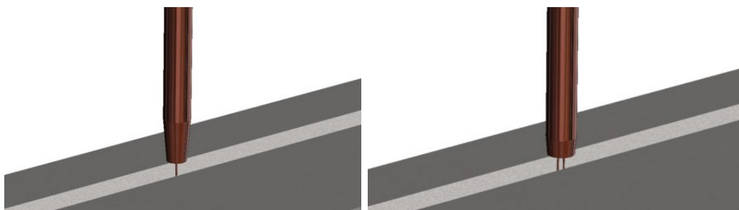
KUVA 12. Jauhekaarihitsauspolttimet, vasemmalla perinteinen ja oikealla kaksoislankapoltin (Pemamek Oy n.d.e)
