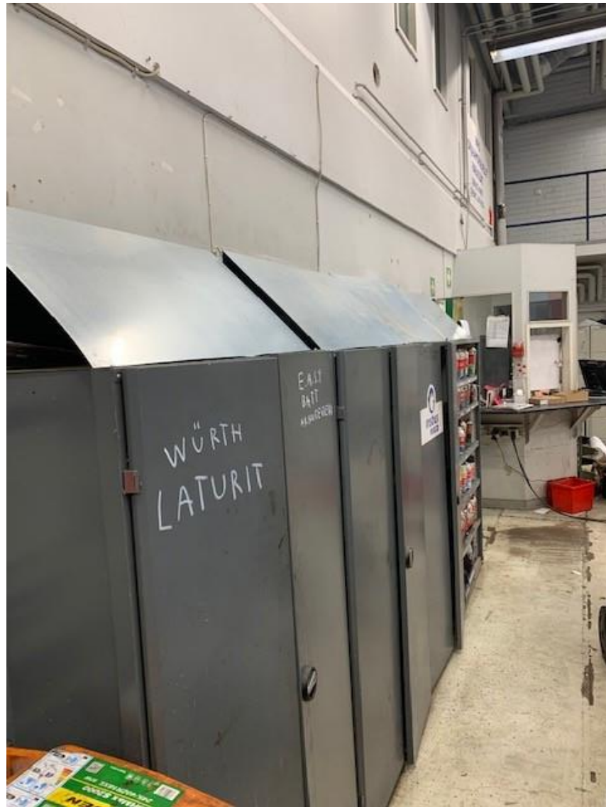
Kuva 15. Kaappien päälle asennetut pellit
