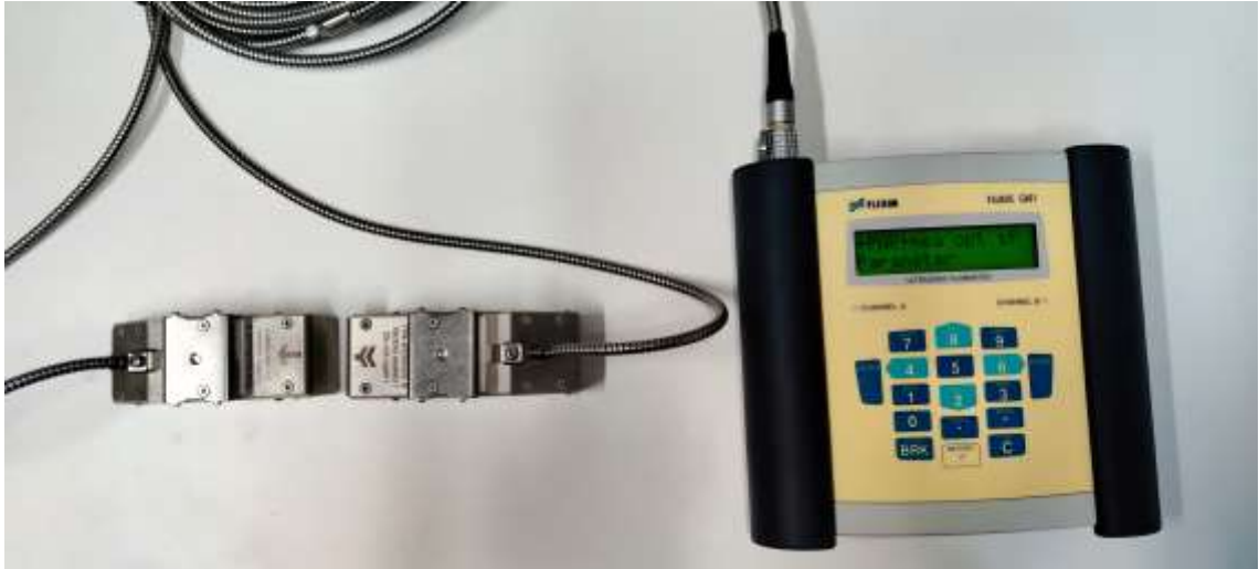
Kuva 7. Flexim Fluxus G601 -virtausmittalaite ja GSK-mallin anturit.
