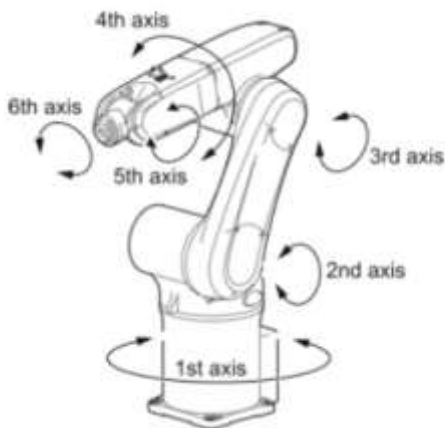
KUVA 9. 6-akselisen käsivarsirobotin akselit (15)
