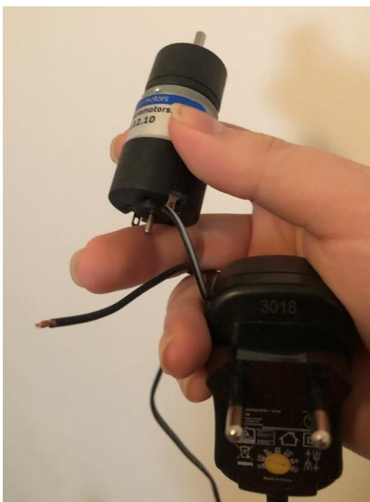
Kuva 8. Hakkuriteholähteen kiinnitys moottoriin.
