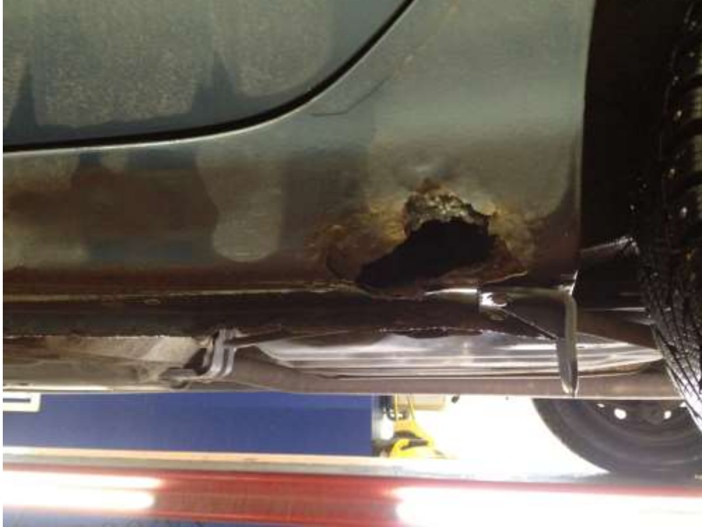
Kuva 65. Tyypillinen korroosioaurioinen helmakotelo.
