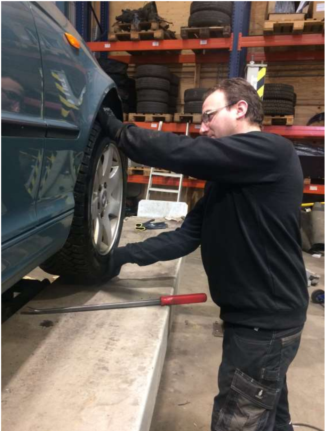
Kuva 35. Pyöränlaakerin kunto, ote. Pyöränlaakeri tarkistetaan pystyotteella ns. klo 12- ja klo 6 -otteella.
