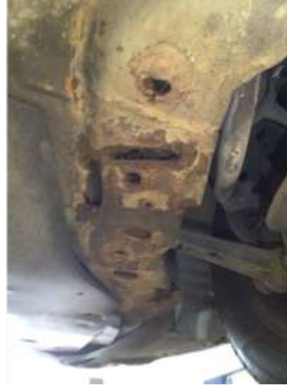
Kuva 17. Kiinnityspalkin korroosioaurio Kuva 18. Kiinnityspalkin korroosioaurio
