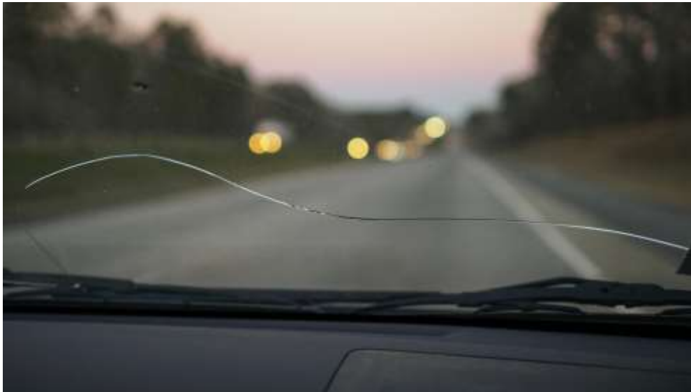
Kuva 8. Halki oleva tuulilasi, korjauskehotus (9).
