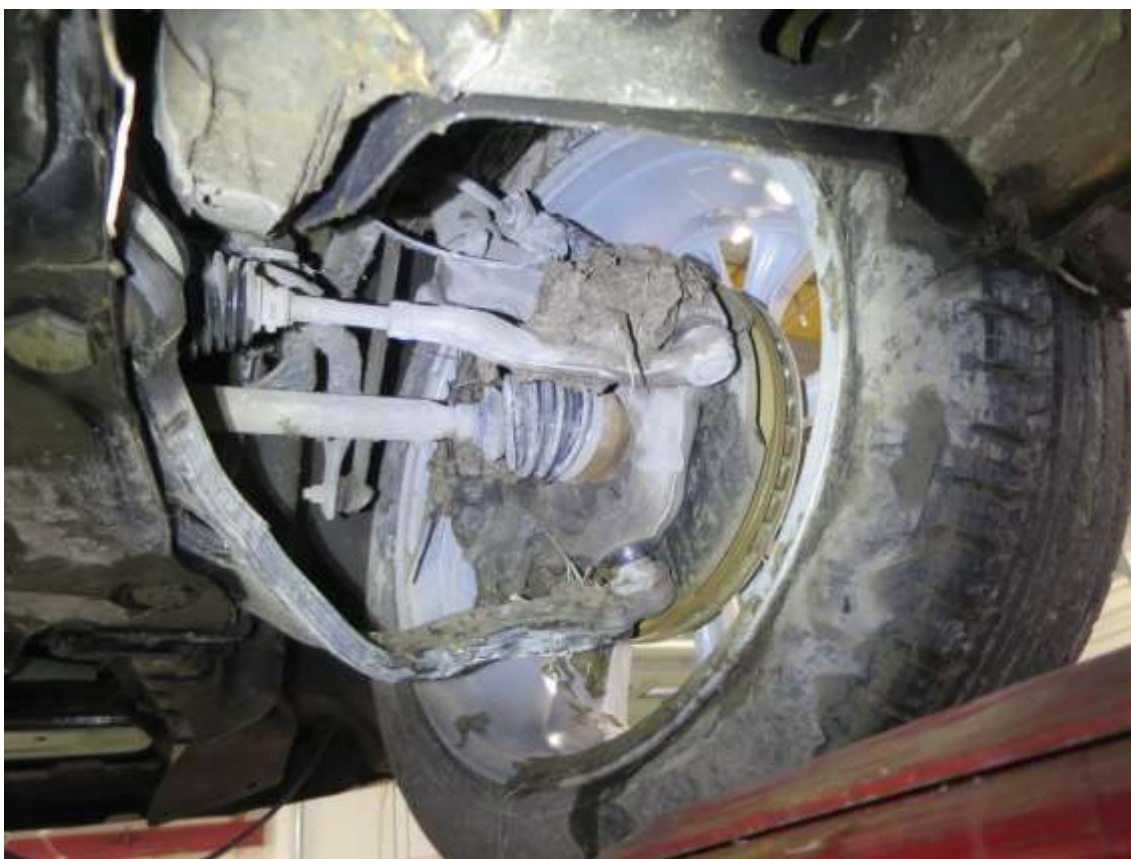
Kuva 42. Alatukivarren vaurio kolarin tuloksena (21).
