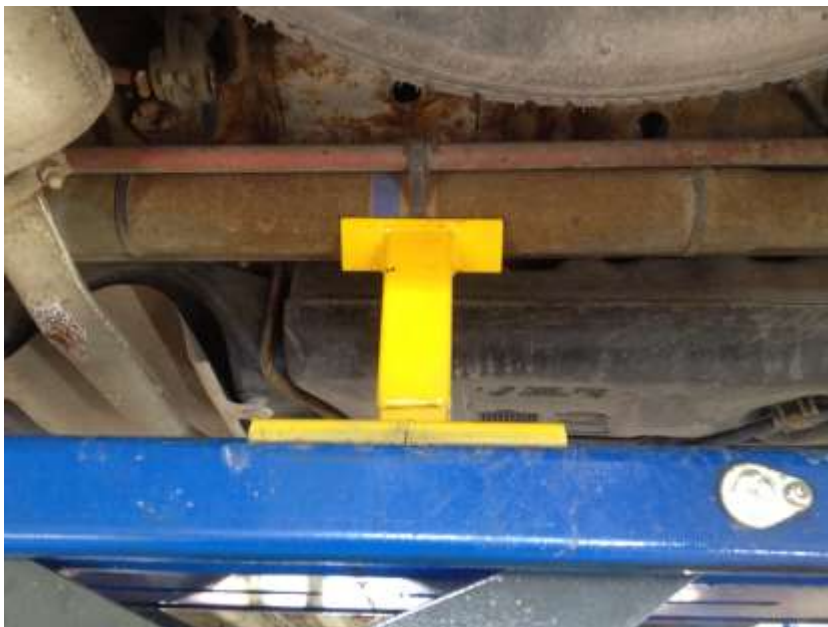
Kuva 60. Korissa kiinniolevan, erillisillä laakeroiduilla tukivarsilla varustetun heiluriakseliston oikea kevennys, lähikuva.
