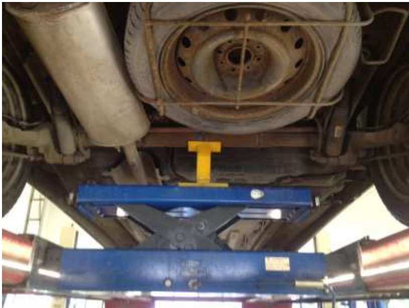
Kuva 59. Korissa kiinniolevan, erillisillä laakeroiduilla tukivarsilla varustetun heiluriakseliston oikea kevennys.
