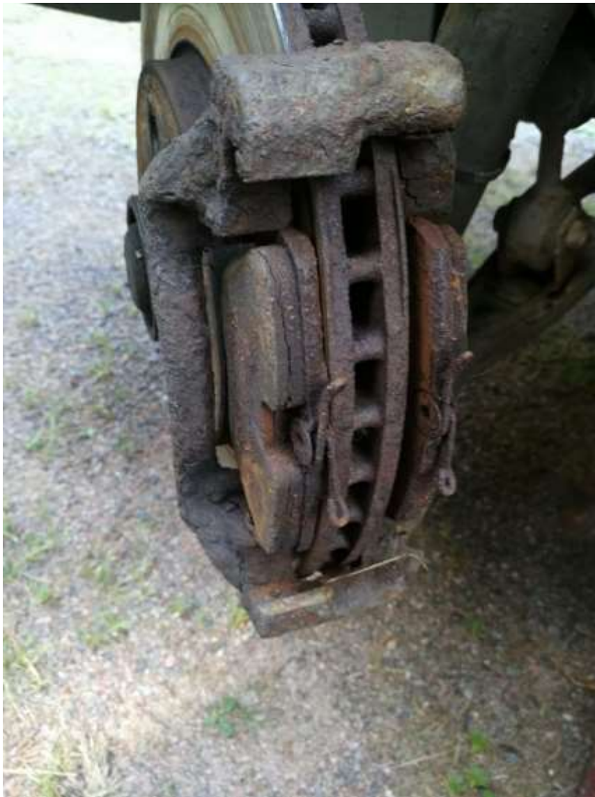
Kuva 66. Jarrupalat asennettuna virheellisesti.
