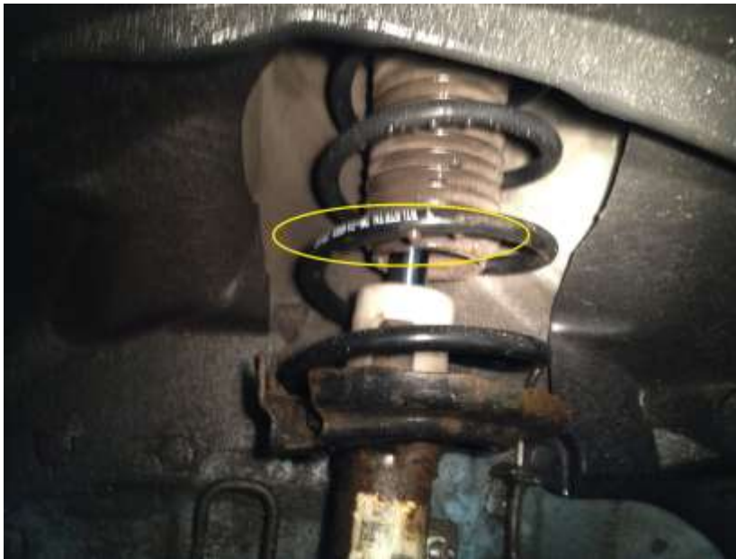
Kuva 24. Asennusvirhe; jousi ylösalaisin.
