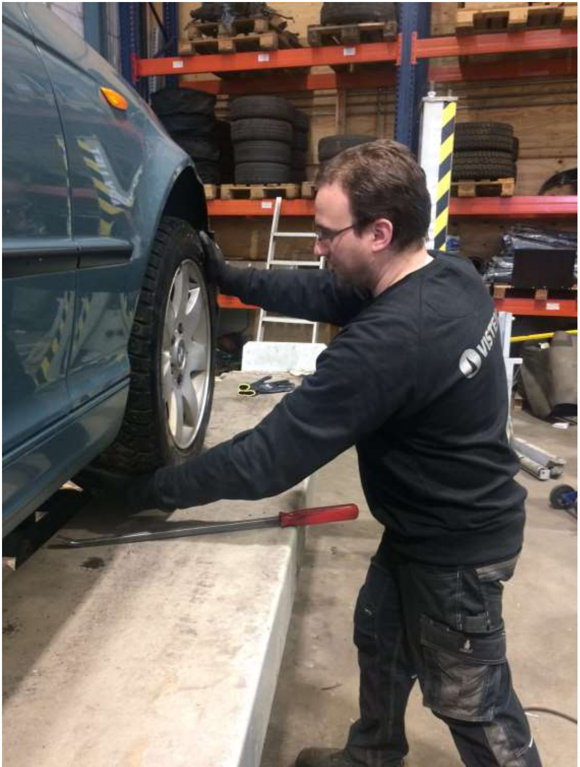
Kuva 39. Pyöräntuennan välykset. Ote on ns. klo 8 - klo 2 -ote, mutta väännetään vastakkaiseen suuntaan.
