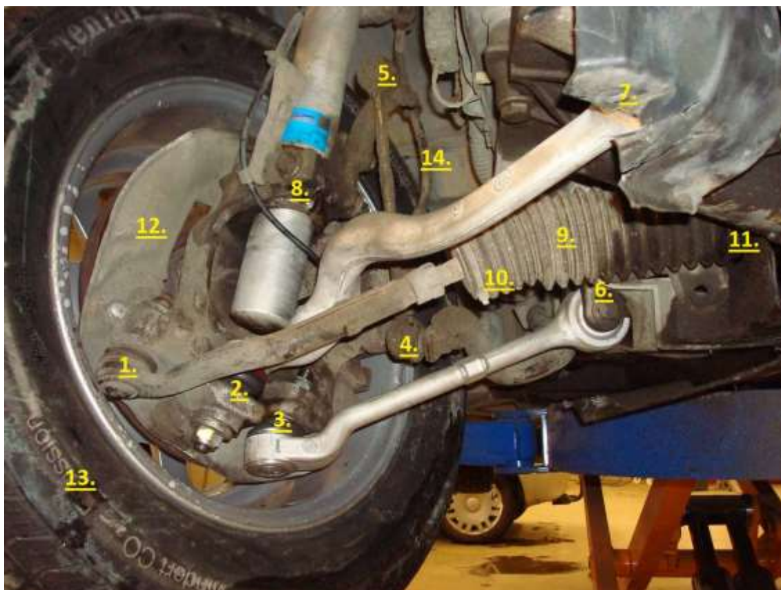
Kuva 41. Pyöräntuennan tarkastuskohteet numeroituna. (20).
