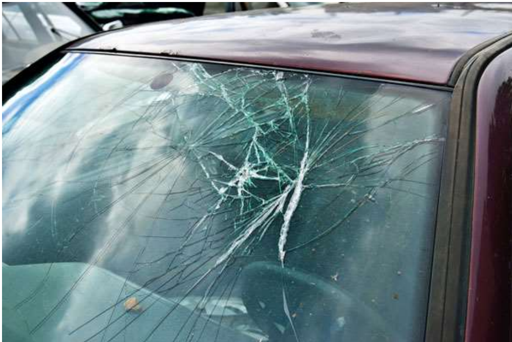
Kuva 10. Vakavasti vaurioitunut tuulilasi; ajokielto (11).
