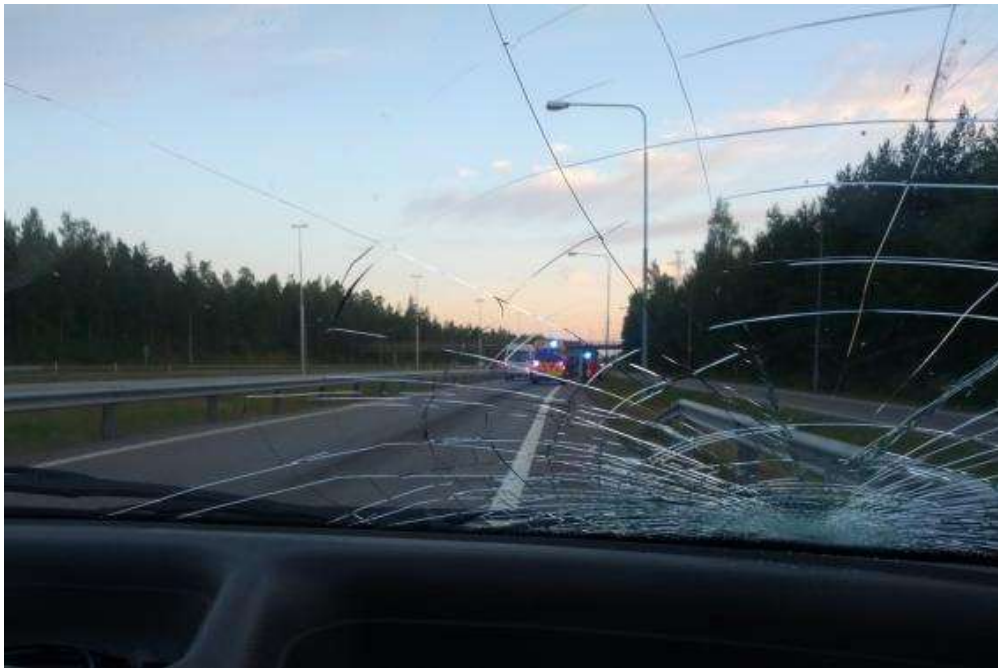
Kuva 9. Vaurioitunut tuulilasi, useita säröjä; hylkäys (10).
