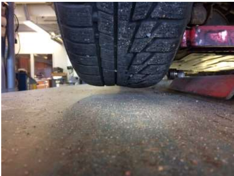
Kuva 33. Runkovaurioinen rengas 2 pyörintäsuunnasta katsottuna.
