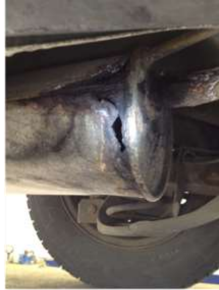
Kuva 62. Äänenvaimennin ruostunut puhki.
