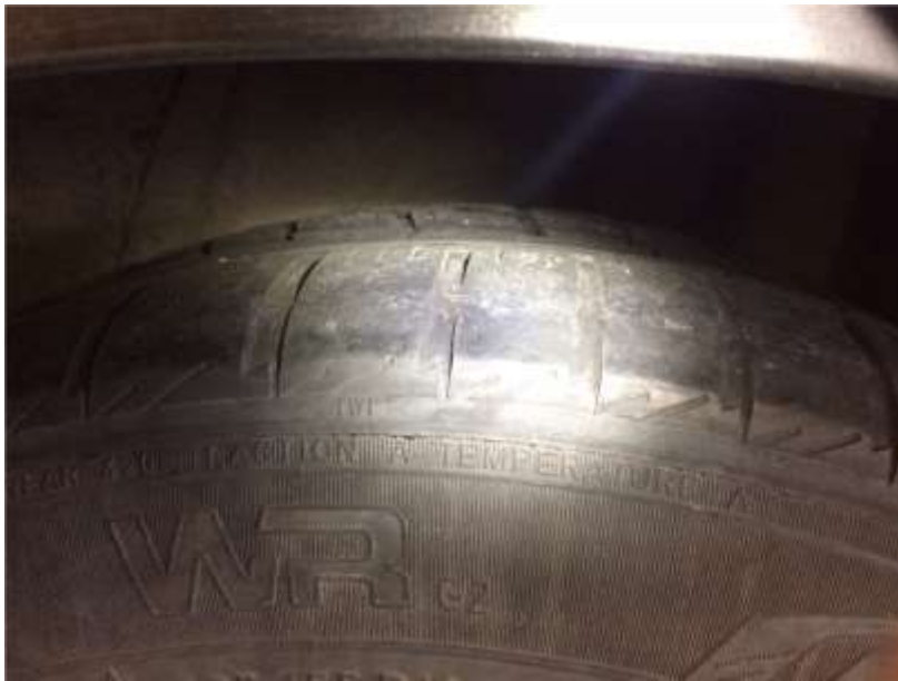
Kuva 32. Rengas 2 runkovaurioinen kohta
