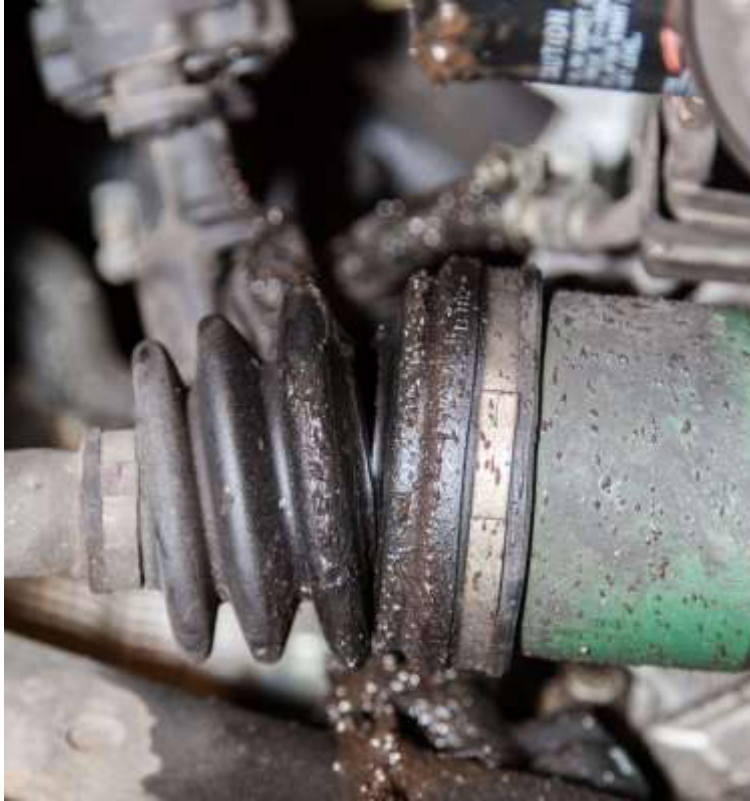
Kuva 44. Vaurioitunut vetonivelen suojakumi (23).
