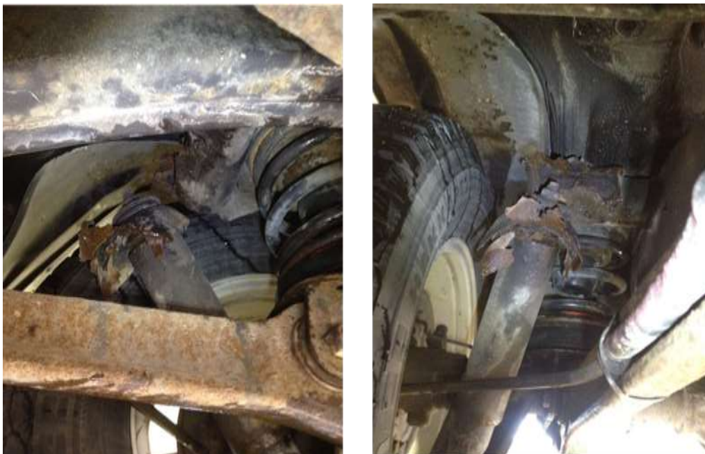
Kuvat 47 ja 48. Kuvissa iskunvaimennin on katkennut kokonaan irti rungosta kiinnityspisteineen.
