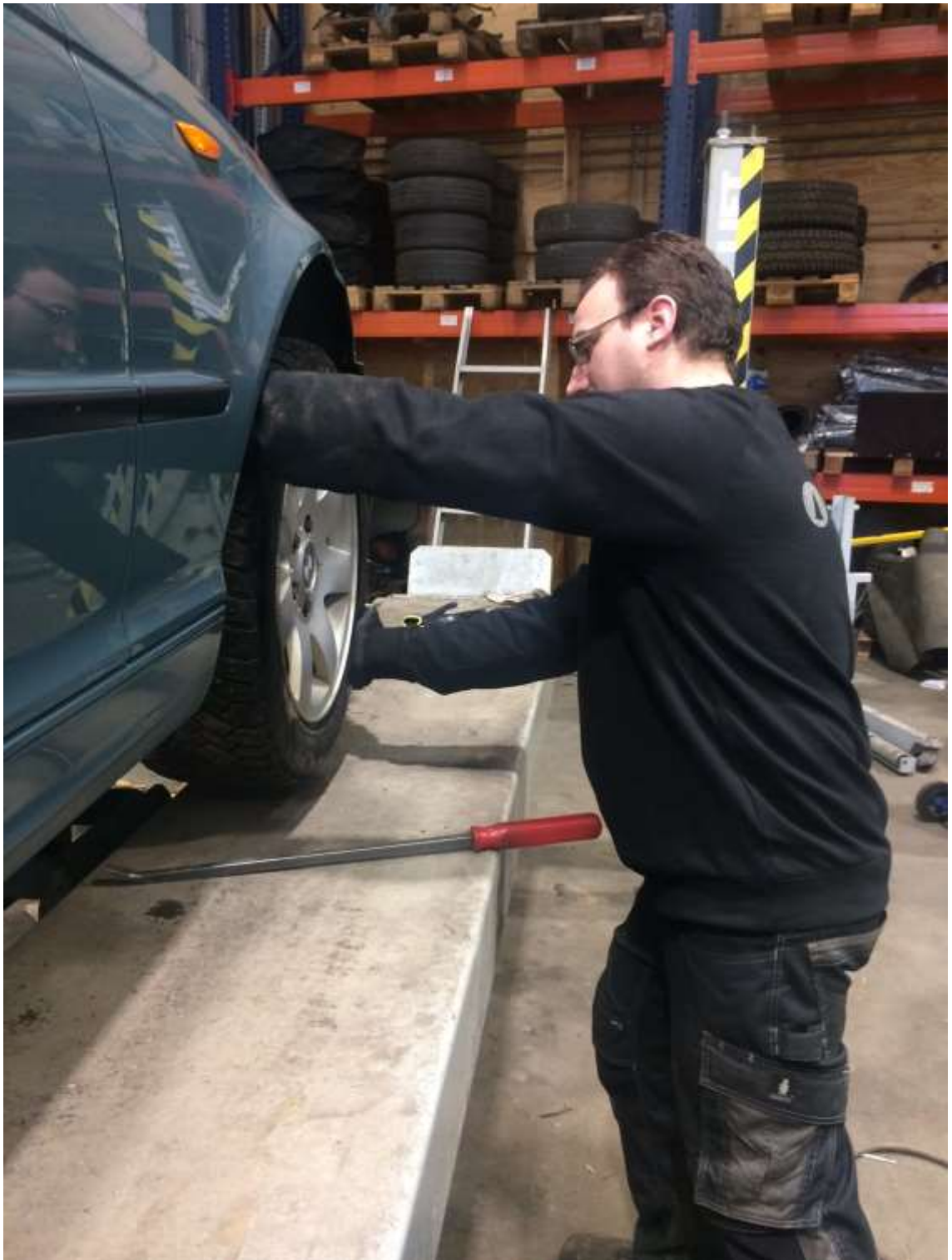
Kuva 37. Pyöräntuennan välykset. Ote on ns. klo 10 - klo 4 -ote, mutta väännetään vastakkaiseen suuntaan.
