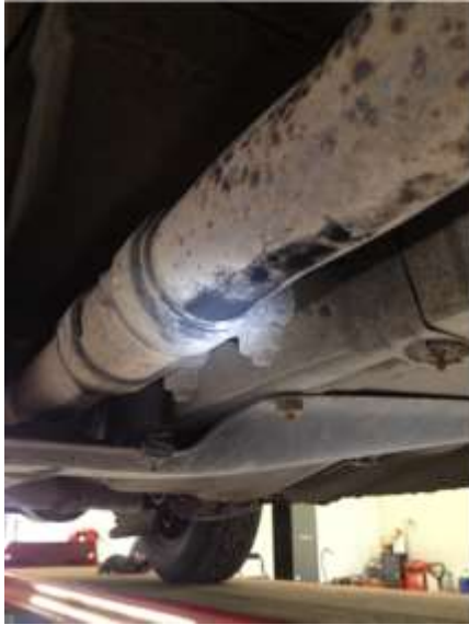
Kuva 61. Pakoputki ruostunut puhki.
