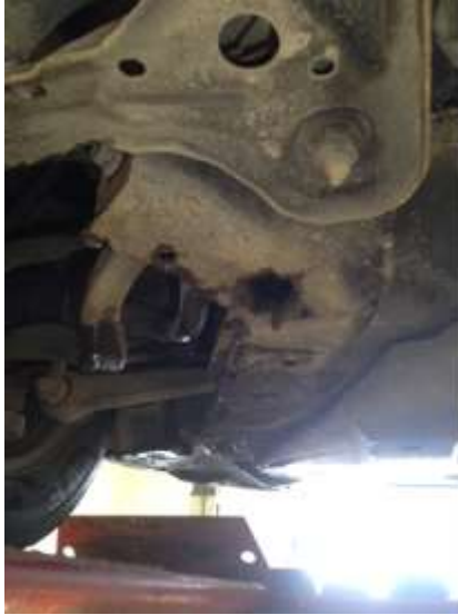
Kuva 17. Kiinnityspalkin korroosioaurio Kuva 18. Kiinnityspalkin korroosioaurio
