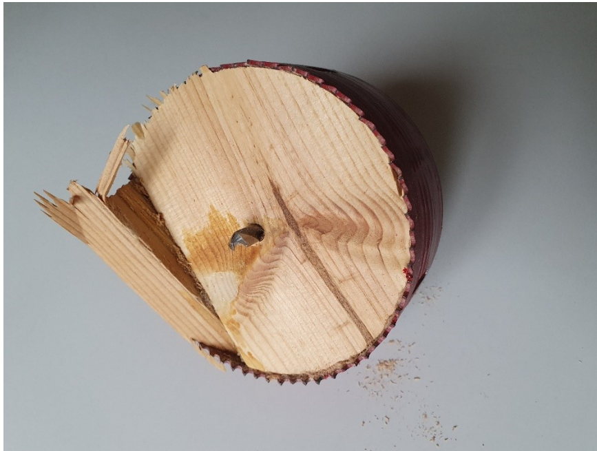
Kuva 15. Ponttilaudan alapuoli näyttää terveeltä.
