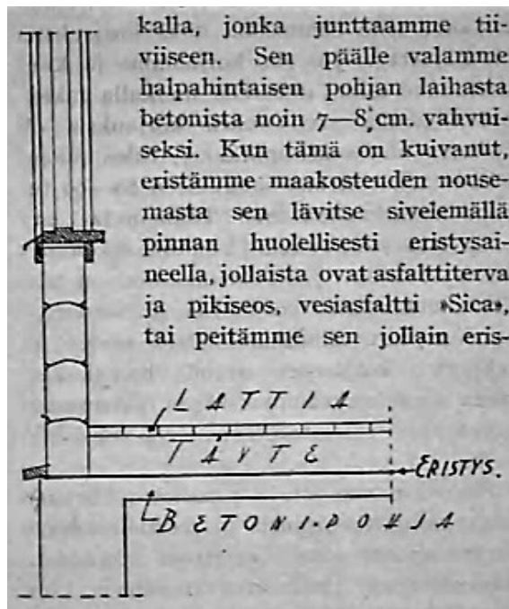
Kuva 2. Multapenkkialapohjan korjaus maanvaraisella alapohjalla esiteltiin Suomen Maatalousseurojen aikakauslehdessä v. 1929 (Maa, 1929, s. 214).
