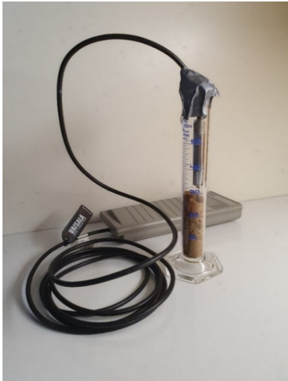
Kuva 17. Maanäytteen kosteuspitoisuuden mittausjärjestely.
